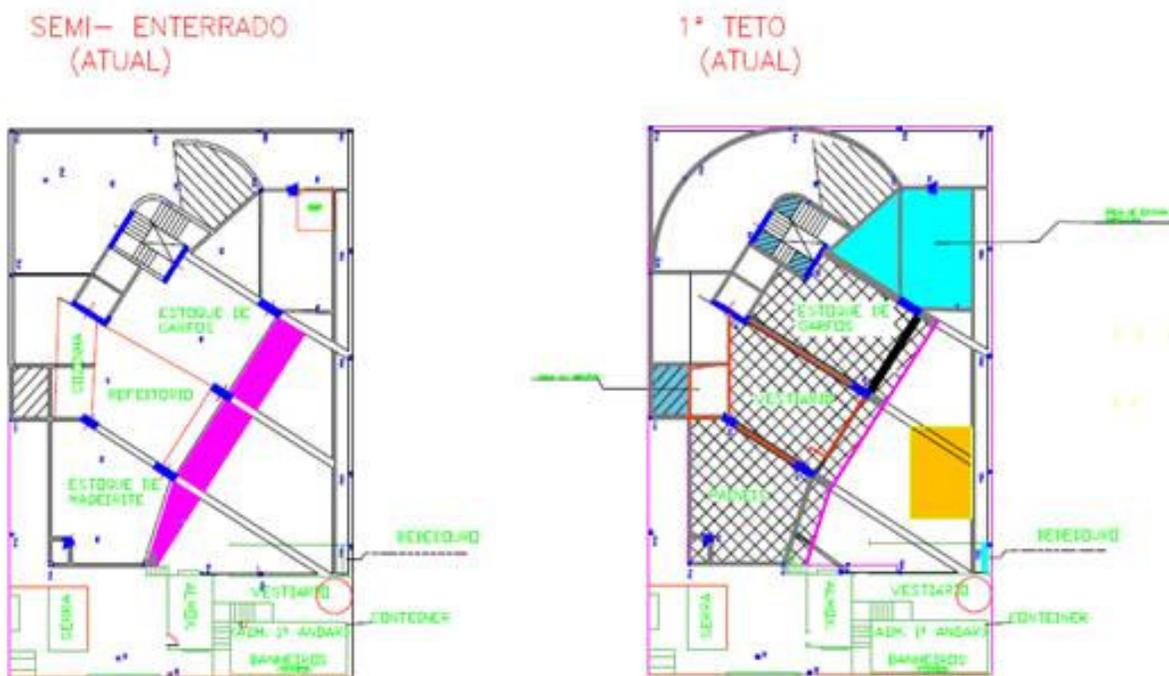
Figura 22 - Projeto de layout do canteiro de obras. Fonte: ilustração fornecida pela Empresa A
