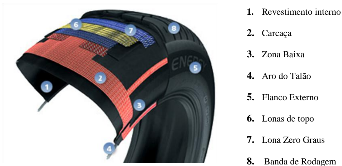
Figura 1 - Detalhamento da Estrutura de um pneu (MICHELIN, 2014).
