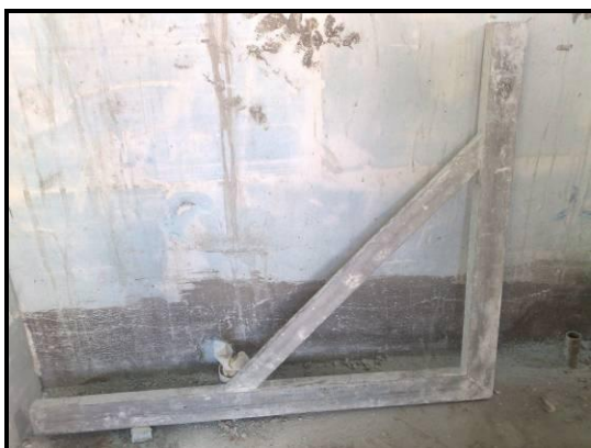
Figura 53 – Esquadro de alumínio para conferência do serviço
