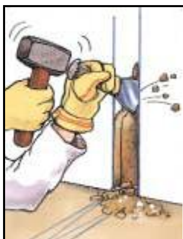
Figura 74 – Preparação da fixação da alvenaria para a execução da vedação com blocos de gesso (ISOLAVA, 2009)
