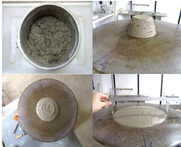
Figura 4 – Ensaio de mesa de consistência ( flow table )
