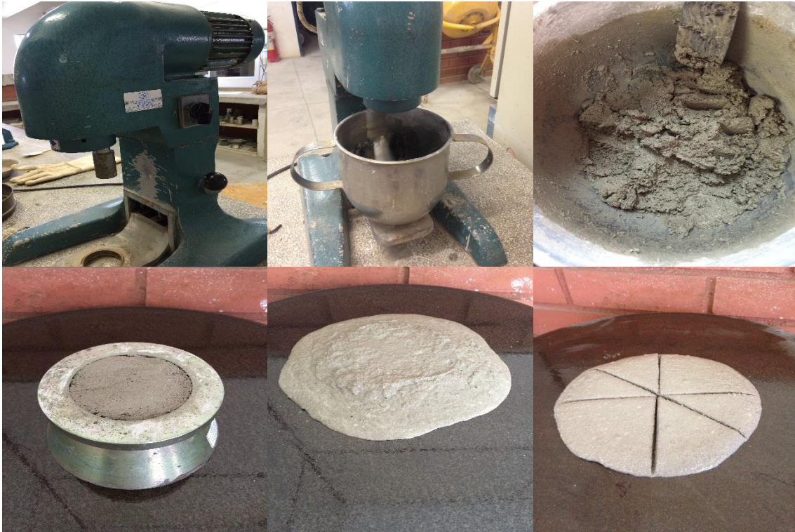
Figura 23 – Etapas do ensaio de mesa de consistência ( flow table )
