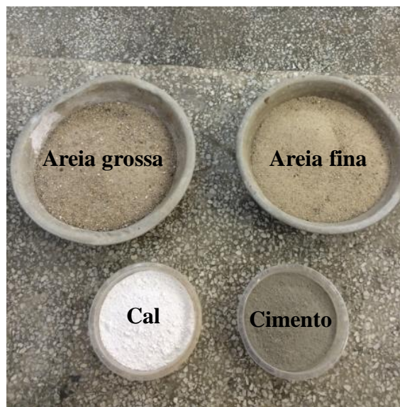
Figura 17 – Materiais utilizados na preparação das argamassas de revestimento
