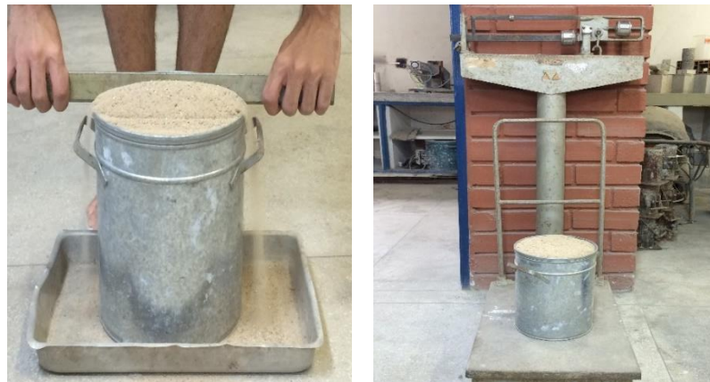
Figura 20 – Arrasamento e pesagem para determinação da massa unitária dos agregados miúdos
