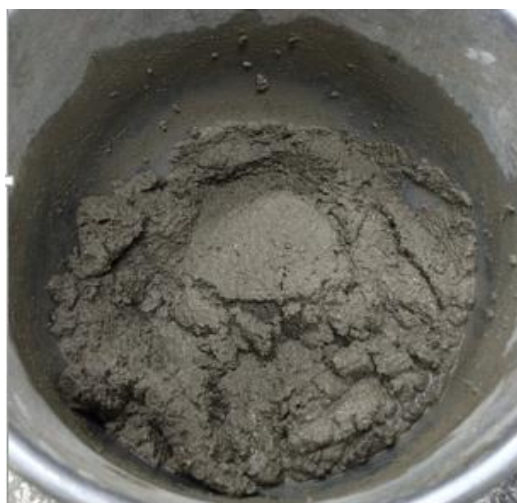
Figura 22 – Traço (TR2) de argamassa de revestimento finalizado
