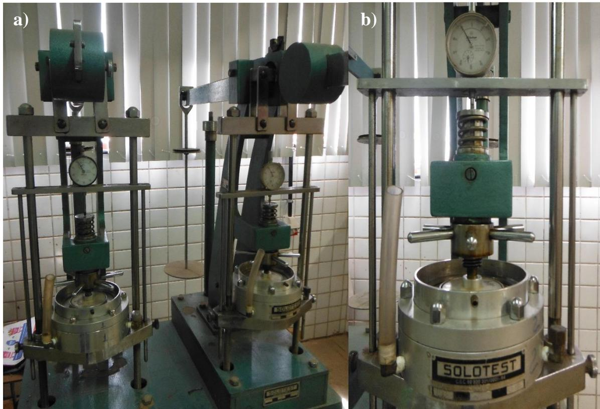
Na medição de variação de altura dos corpos de prova utilizou-se um extensômetro com sensibilidade de 0,01mm. Os ensaios de compressão edométrica foram executados segundo as recomendações da NBR 12007/90, com a finalidade de obter os índices de compressibilidade unidimensional do solo e das misturas de solo com resíduo, com e sem inundação do material.
