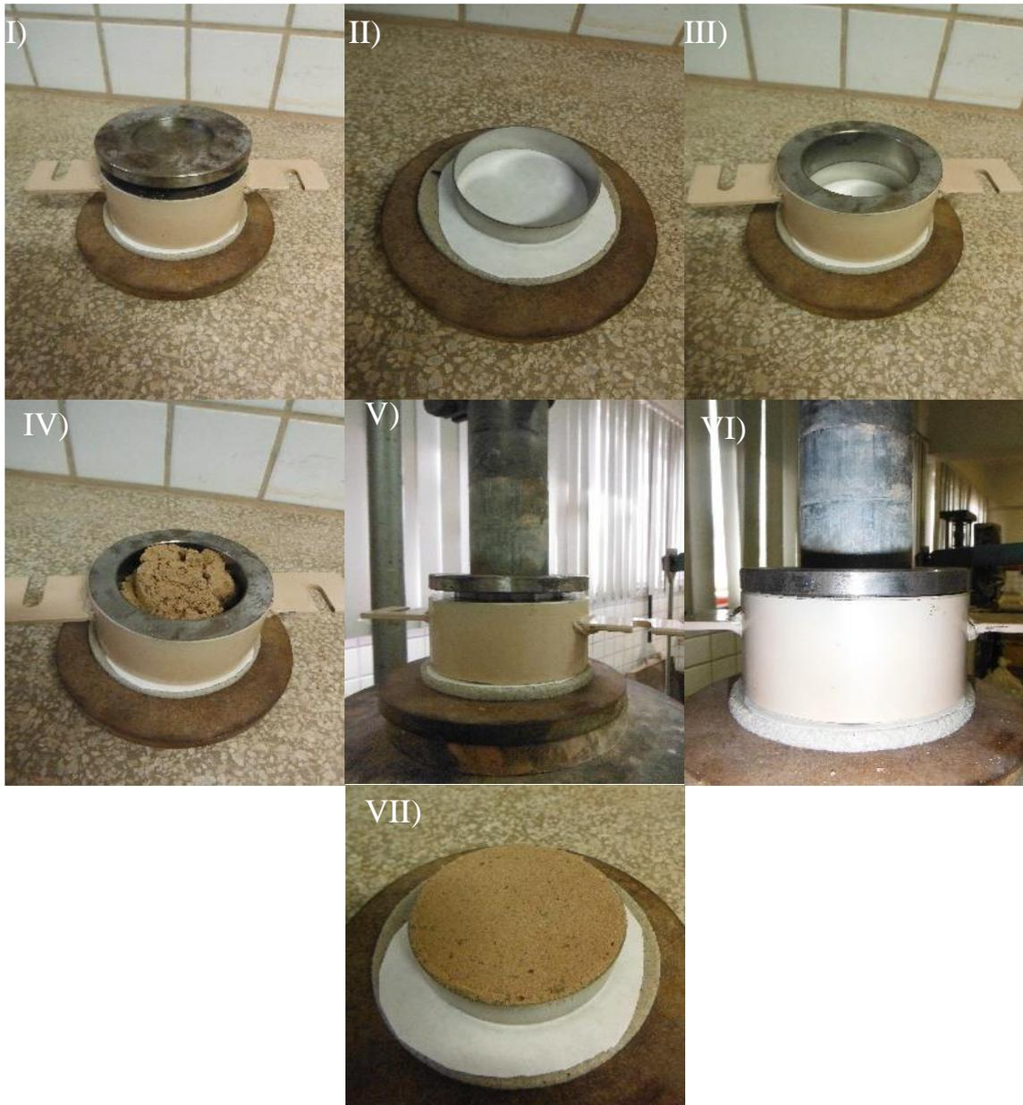
Figura 42 - Esquema de montagem das células edométricas convencionais.
