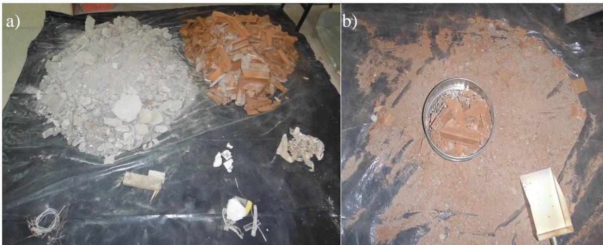
Figura 32 – Amostras homogeneizadas (a) e Amostra ensacada (b).
