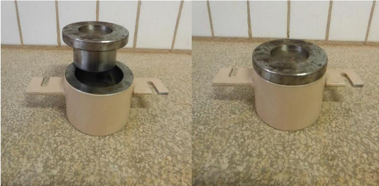
Inicialmente, calculava-se o peso da amostra necessária de solo para cada ensaio a ser realizado, respeitando sempre o grau de compactação e umidade da amostra. O processo de confecção dos CP's e o esquema de montagem das células edométricas convencionais estão apresentados na Figura 41 e Figura 42, respectivamente.
