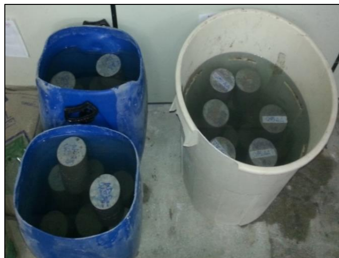
Figura 15 - Cura úmida (imersão total) dos corpos de prova
