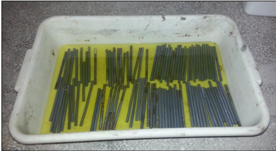
Figura 10 - Imersão das barras de aço em solução de ácido clorídrico 1:1
