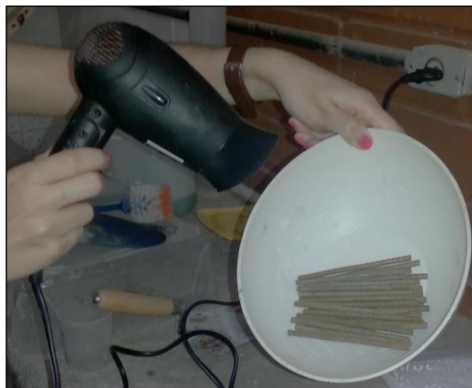
Figura 13 - Secagem das barras de aço e armazenamento em depósito com sílica
