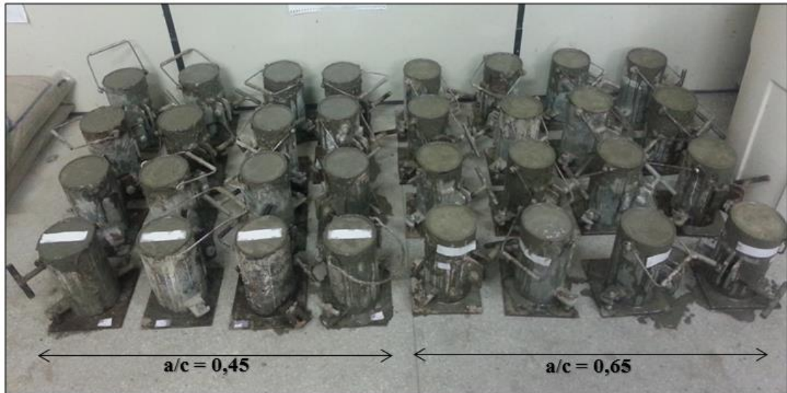
Figura 14 - Corpos-de-prova do tipo cilíndrico, moldados e identificados.
