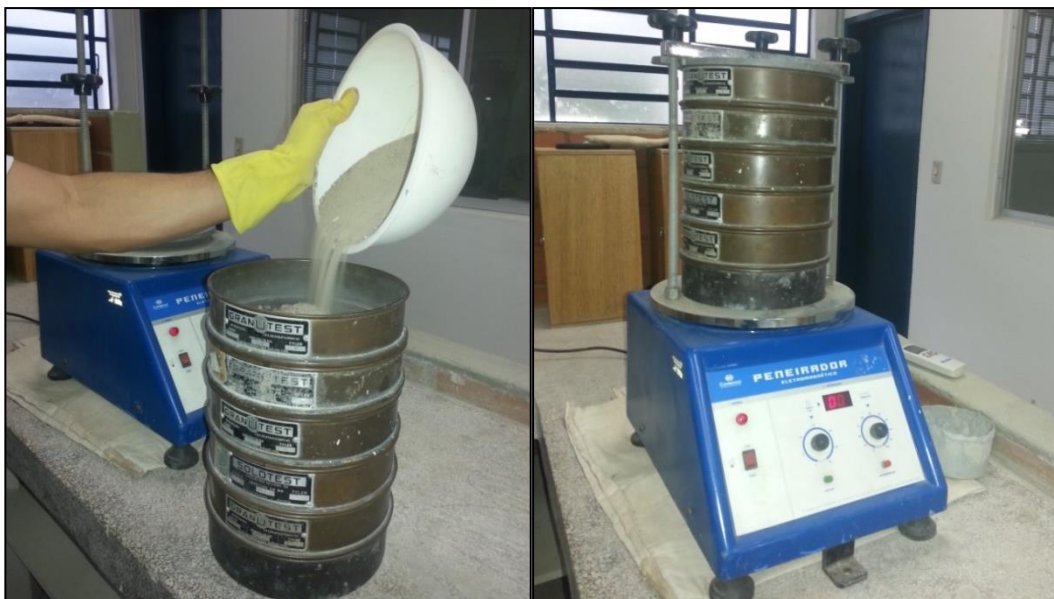
Figura 8 - Ensaio granulométrico do agregado miúdo
