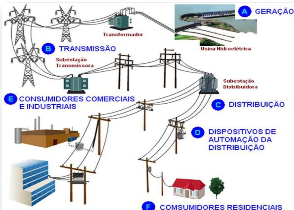
Figura 5 - Sistema Elétrico de potência
