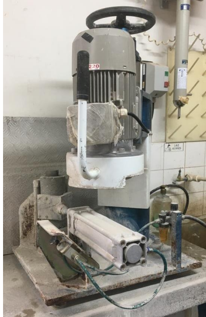
Figura 9 - Retificação dos corpos de prova
