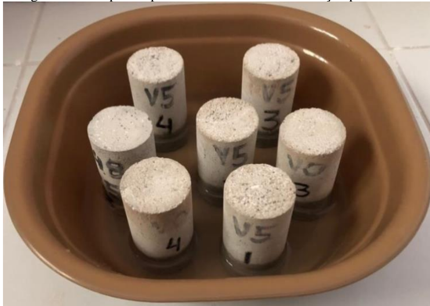
Figura 12 - Corpos de prova durante ensaio de absorção por imersão
