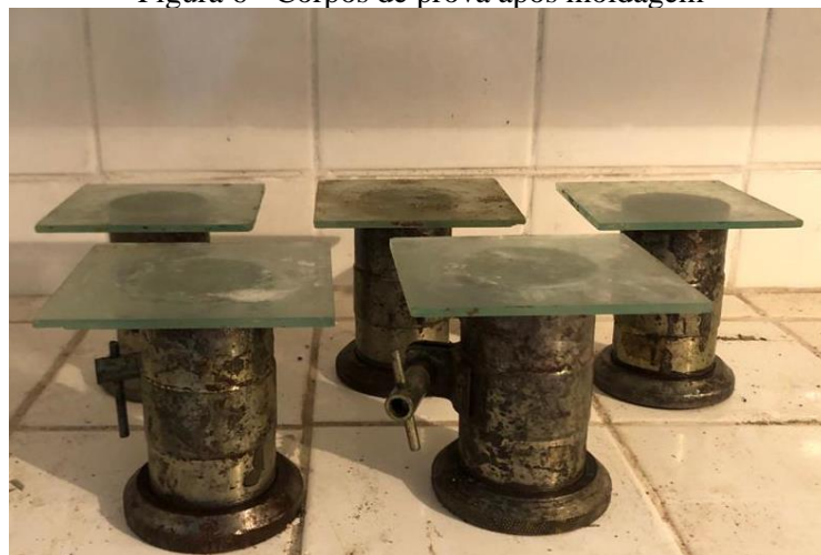
Figura 6 - Corpos de prova após moldagem
