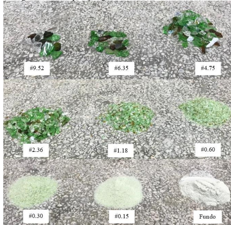
Figura 17 - Composição granulométrica do resíduo de vidro
