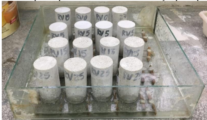
Figura 13 - Corpos de prova durante ensaio de absorção por capilaridade
