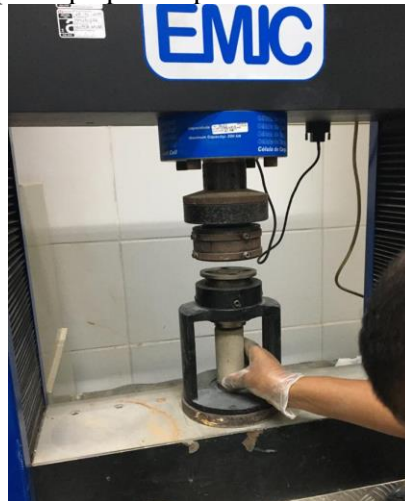
Figura 10 - Corpo de prova preparado para o ensaio de resistência à compressão
