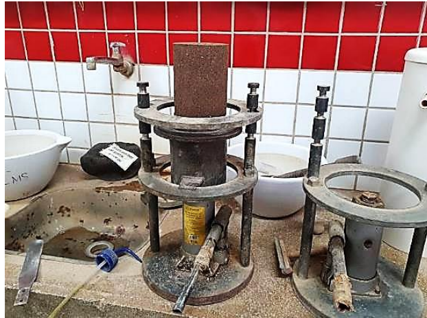
Figura 24 – Retirada amostra em ensaio de compactação.
