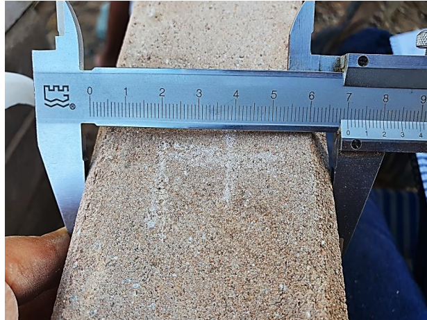
Figura 30 – Controle tecnológico dos tijolos
