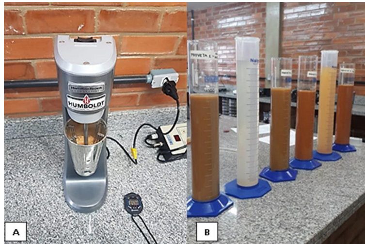
Figura 21 – Dispersor (A) e Ensaio de sedimentação (B)
