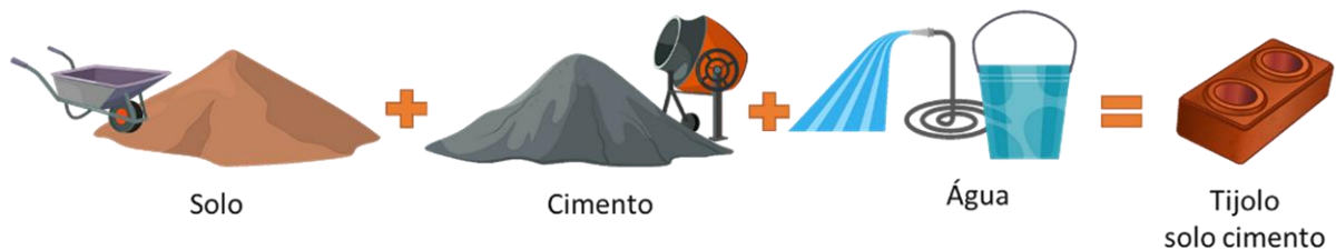
Figura 7 – Produção tijolo solo cimento conforme NBR 12023
