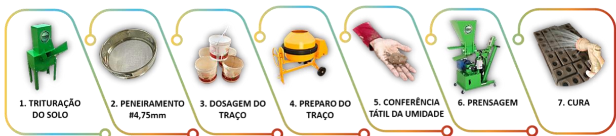
Figura 28 - Etapas de produção dos tijolos
