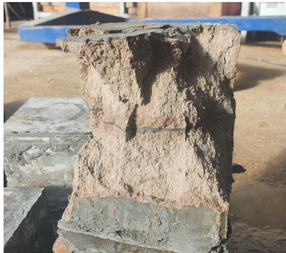
Figura 47 – Tijolos após ruptura.
