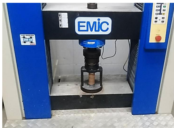
Figura 25 – Corpo de prova submetido ao em ensaio de compressão.
