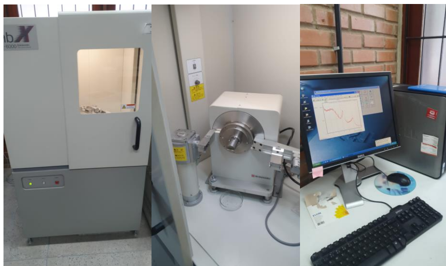
Figura 27 – Realização do ensaio de difratometria de Raios-X
