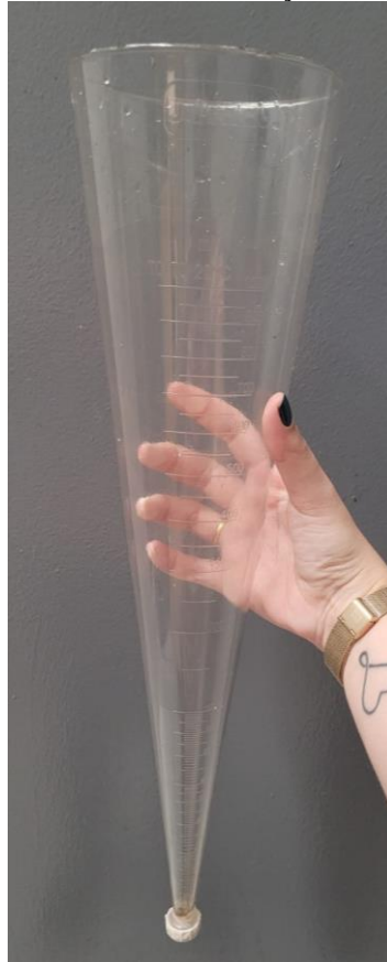
Figura 30 - Funil Graduado utilizado na Medição da Água do Ar Condicionado
