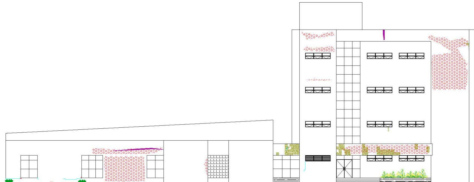
Figura 53 – Mapa de danos definitivo da fachada Noroeste do Fórum de Olinda – Inspeções visual e termográfica
