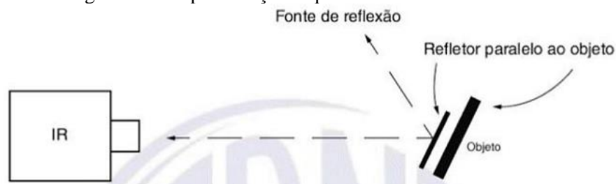
Figura 27 – Representação esquemática do método refletor
