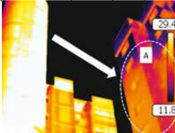
Figura 10 – Imprecisões nas medições de temperatura provocadas pela reflexão
