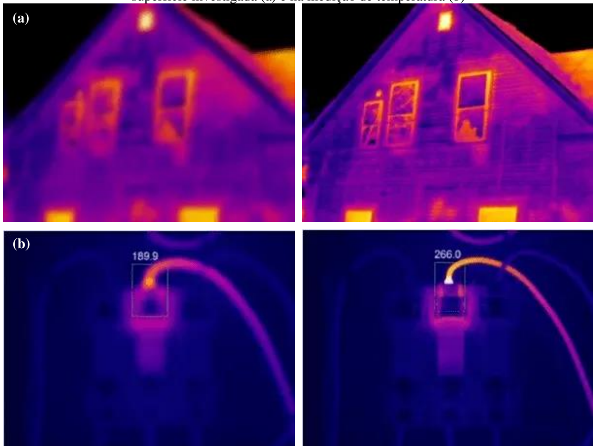
Figura 5 – Influência da variável foco nos termogramas na detecção de anomalias térmicas na superfície investigada (a) e na medição de temperatura (b)
