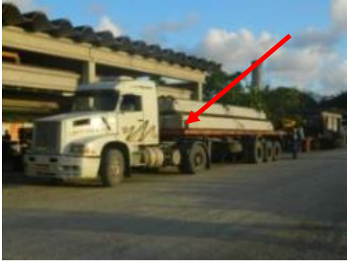
(A) Preparação para o transporte de vigas da fábrica à obra
