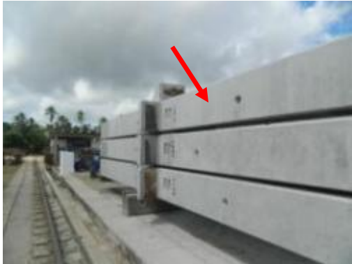
(A) Pilares prontos para a obra, posicionados na lateral da pista de produção.
