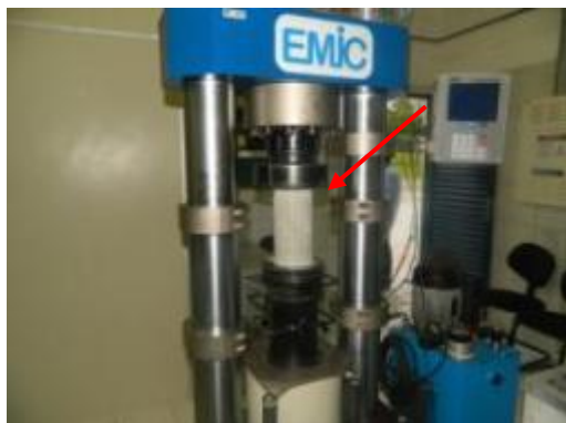
(F) Prensa para teste de compressão de corpos de prova.
