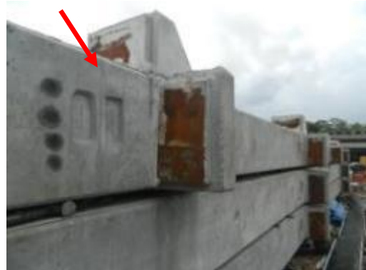
(B) Pilares prontos para o transporte para a obra.
