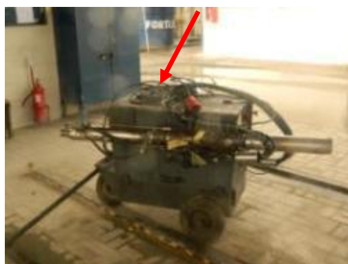
(D) Equipamento para a protensão das cordoalhas
