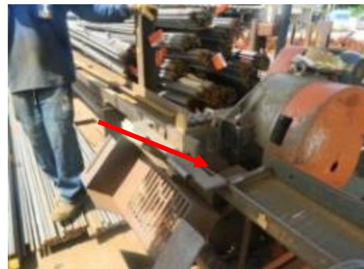
(E) Cortadeira de aço em varões.
