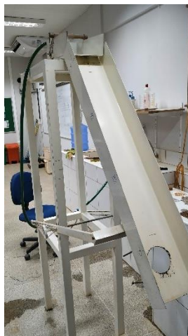
Figura 42 - Equipamento utilizado para análise de erodibilidade
