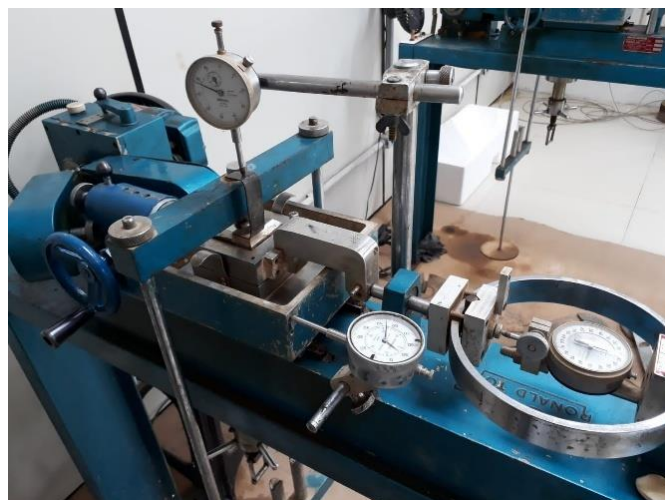
Figura 36 - Ensaio de cisalhamento direto
