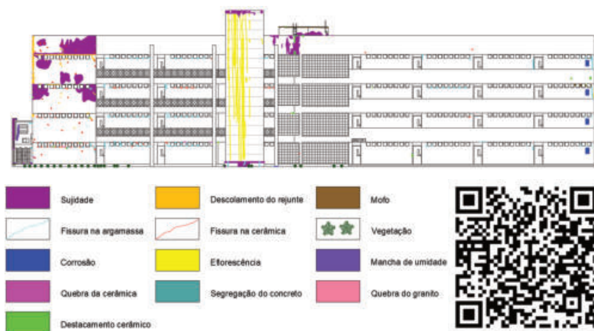
Figura 205 – Mapa de danos da fachada frontal dos blocos I e K
