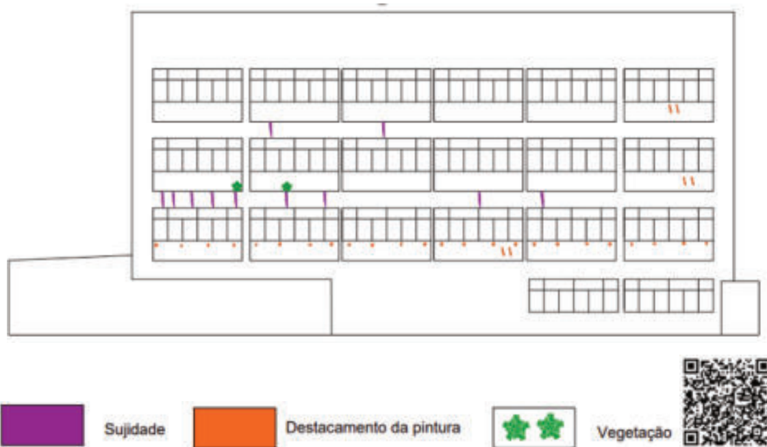
Figura 82 – Mapa de danos da fachada posterior do bloco C
