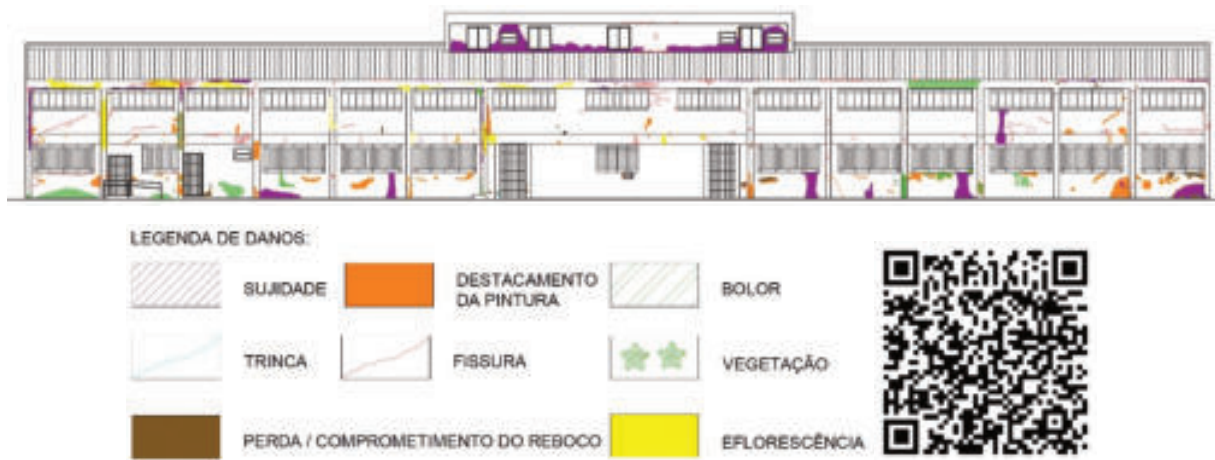
Figura 65 – Mapa de danos da fachada posterior do bloco B
