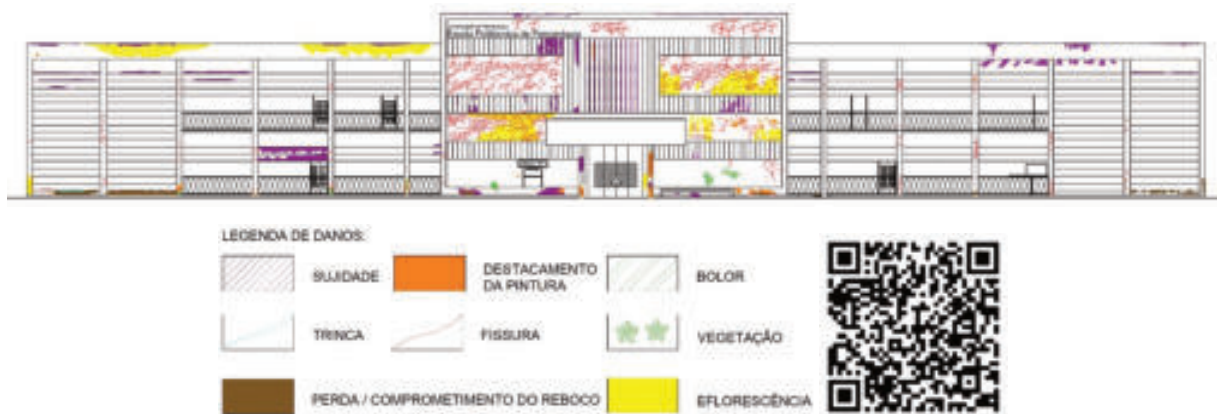
Figura 47 – Mapa de danos da fachada frontal do bloco B
