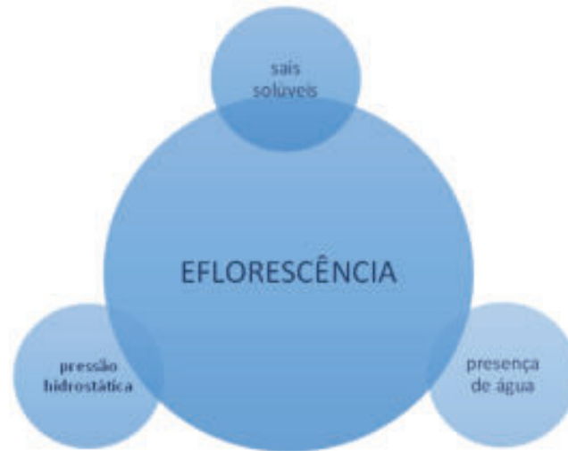
Figura 2 – Fatores necessários para a ocorrência de eflorescência
