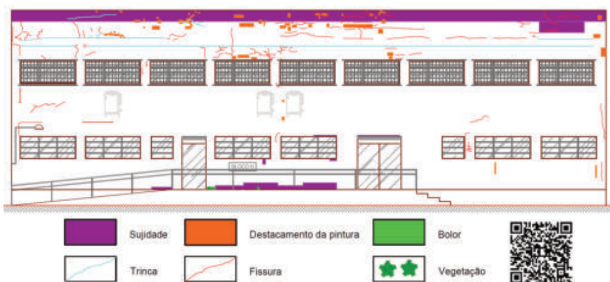
Figura 168 – Mapa de danos da fachada frontal do bloco H
