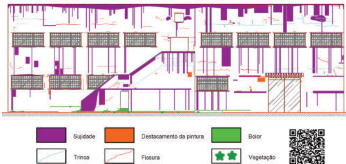
Figura 194 – Mapa de danos da fachada posterior do bloco H
