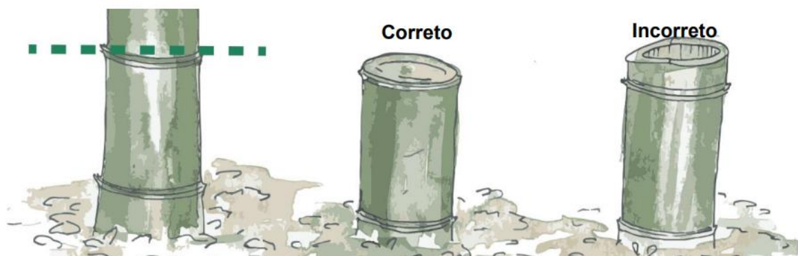
Figura 10 - Corte correto e incorreto do bambu.
