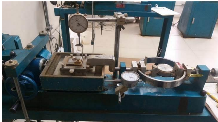
Figura 37- Ensaio de cisalhamento direto
