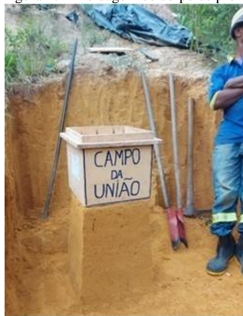
Figura 27 - Moldagem do corpo de prova
