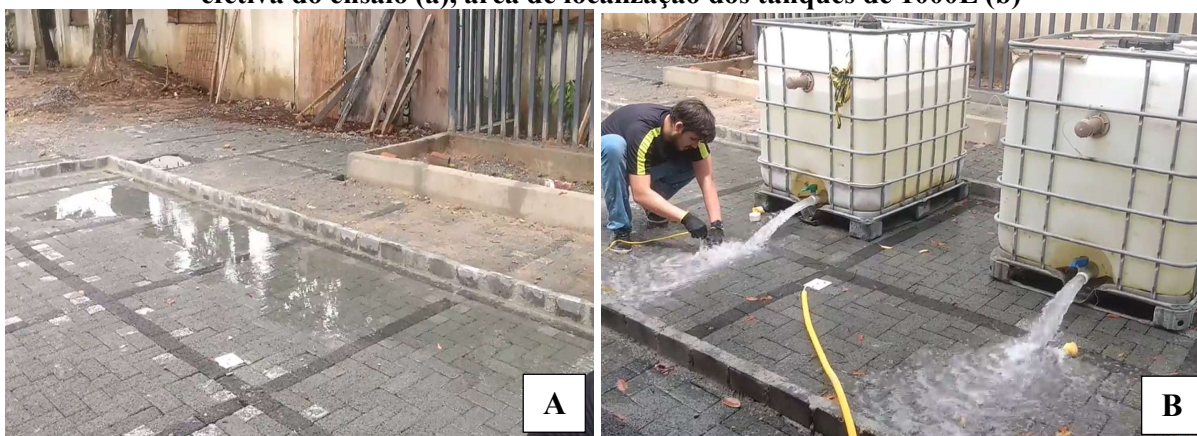
Figura 56 – Lâmina d'água representando a área efetiva da simulação nº01. Área irregular e efetiva do ensaio (a), área de localização dos tanques de 1000L (b)
