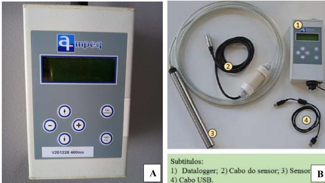
Figura 43 – Medidor de nível d'água automático. Datalogger (a), conjunto AMPEQ (b)
