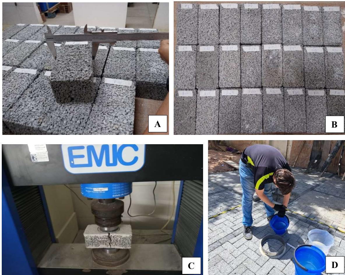
Figura 35 – Ensaios nos blocos de concreto permeável. Avaliação dimensional (a), inspeção visual (b), resistência à compressão (c), coeficiente de permeabilidade (d)
