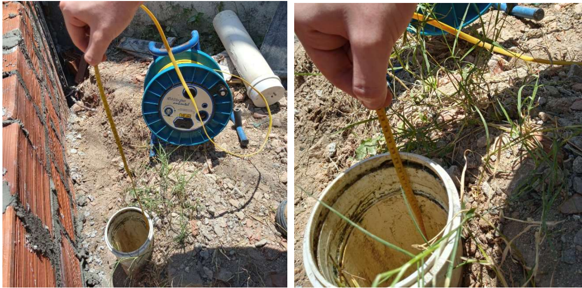
Figura 51 – Realização da medição do nível d'água com o equipamento manual
