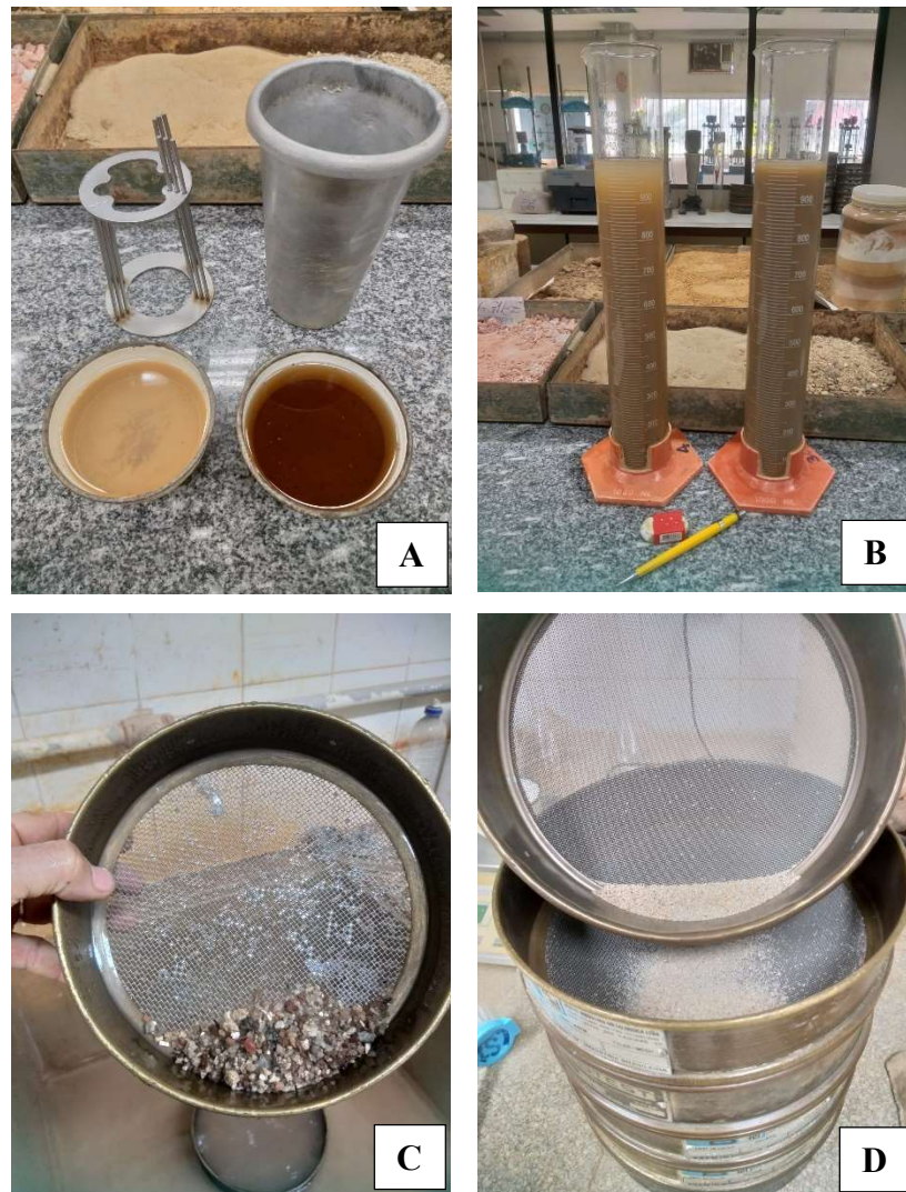
Figura 26 - Realização do ensaio de granulometria. Preparação (a), sedimentação (b), peneiramento grosso (c) e peneiramento fino (d)
