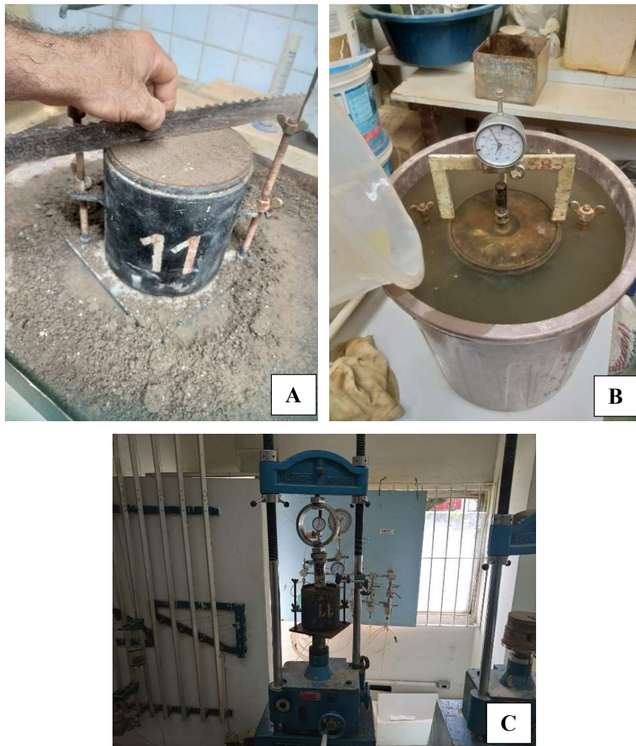
Figura 28 – Ensaio ISC (CBR). Preparação do corpo de prova (a), colocação em tanque de submersão (b), penetração na prensa (c)
