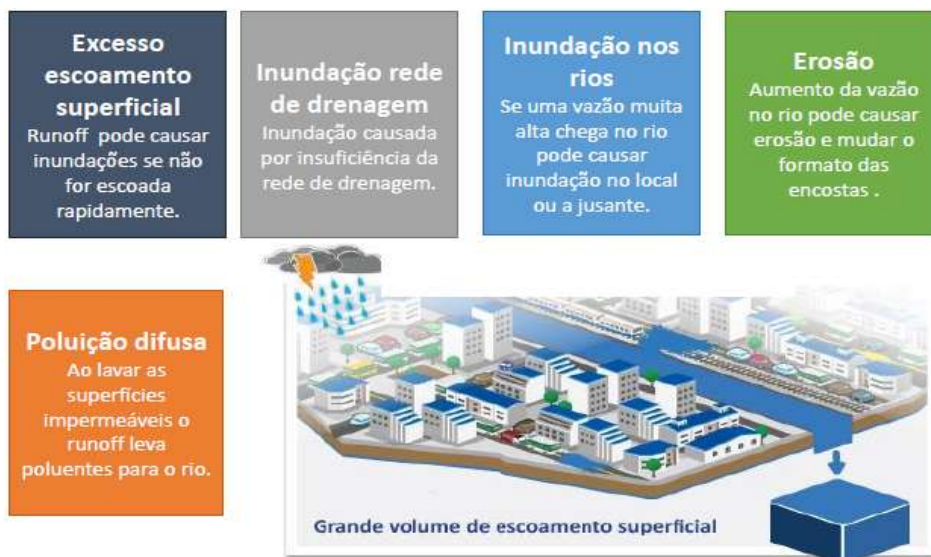
Figura 2 - Alguns aspectos problemáticos relativos à drenagem urbana
