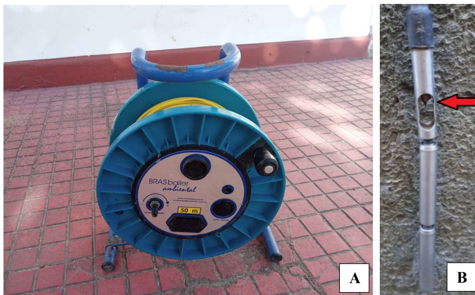
Figura 38 – Equipamento manual de medição de nível d'água (a), indicação do sensor (b)
