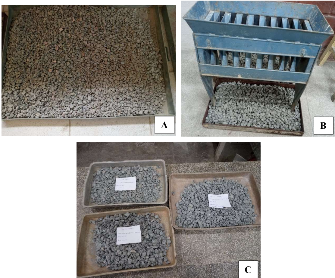
Figura 32 – Redução da amostra de campo para ensaios de laboratório: amostra do material da base (a), quarteador mecânico (b), amostras reduzidas (c)
