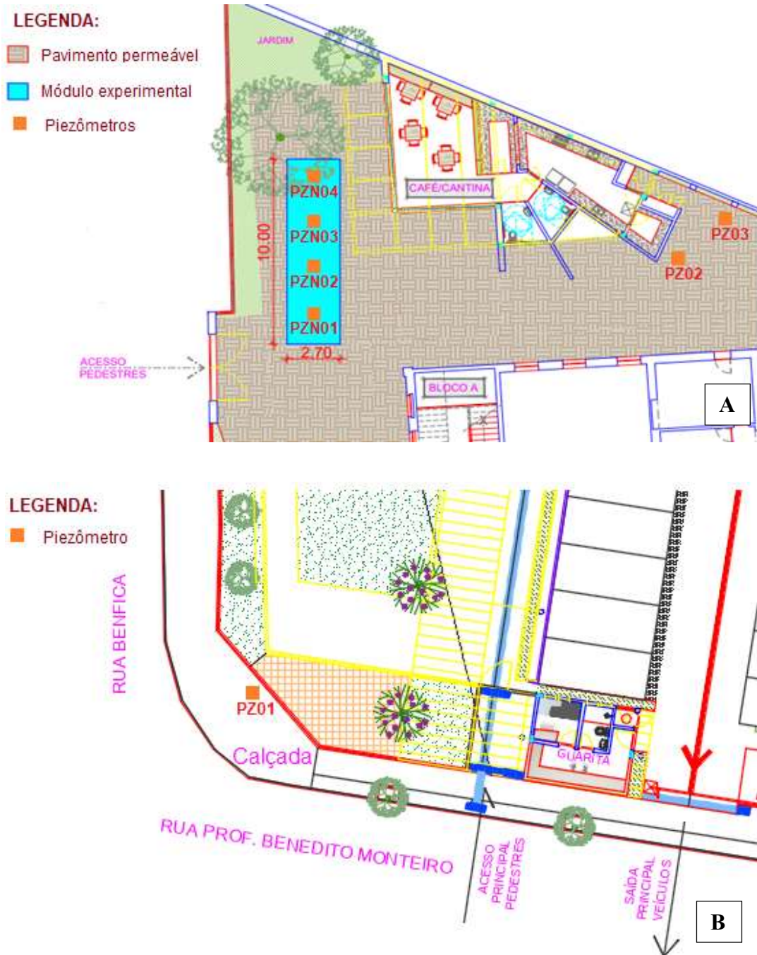
Figura 40 - Localização dos piezômetros. Área onde se encontra o módulo experimental e os piezômetros PZ02, PZ03, PZN01, PZN02, PZN03, PZN04 (a), recorte da área de entrada da POLI-UPE onde se localiza o piezômetro PZ01 (b)
