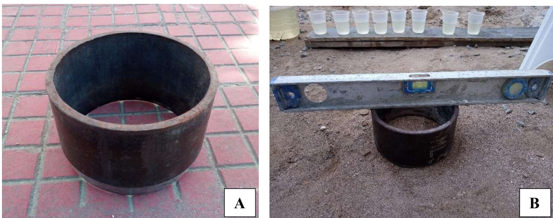
Figura 30 – Ensaio de permeabilidade em campo. Infiltrômetro (a), nivelamento e copos com os volumes a serem vertidos na realização do ensaio (b)
