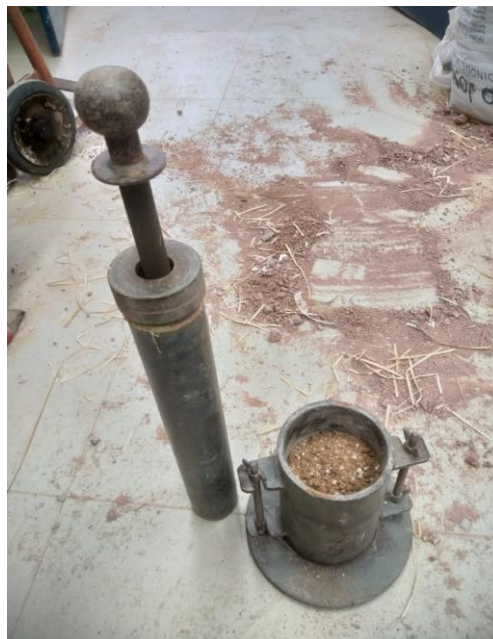
Figura 33: Ensaio de compactação do solo.
