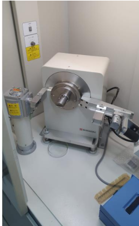
Figura 30: Difratorômetro Shimadzu XRD6000, utilizado para o ensaio de Difratometria de Raio -X.
