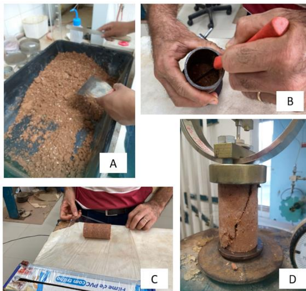
Figura 36: Preparação do corpo de prova para ensaio de Resistência à Compressão Simples (A) Preparação; (B) Moldagem; (C); Preparação do corpo de prova para câmara úmida; (D) Rompimento do corpo de prova.
