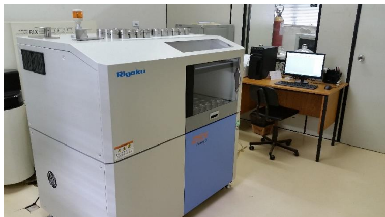
Figura 31: Equipamento para ensaio de fluorescência de Raio-X - Rigaku, modelo ZSX Primus II.
