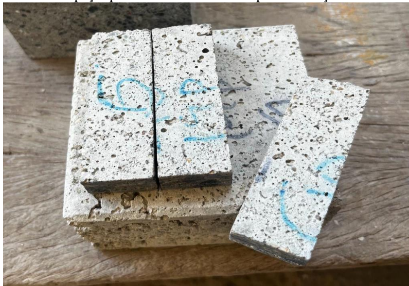
Figura 24 – Corte de peças produzidas manualmente para realização do ensaio de abrasão
