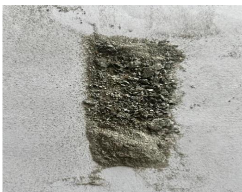
Figura 18 – Fragmentos da área central do bloco intertravado de concreto triturado F12
