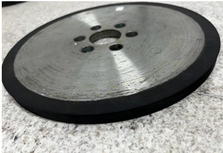
Figura 26 – Disco de borracha vulcanizada utilizada no ensaio de abrasão
