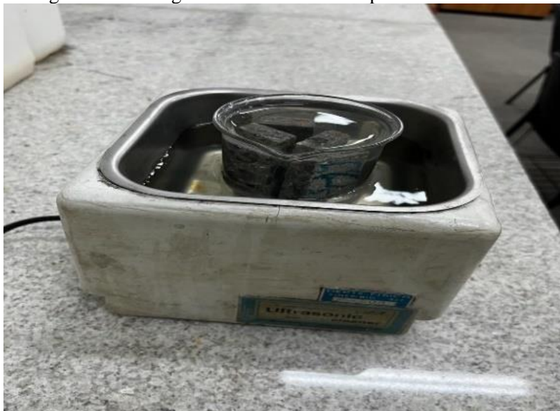
Figura 31 – Lavagem das amostras com aparelho de ultrassom
