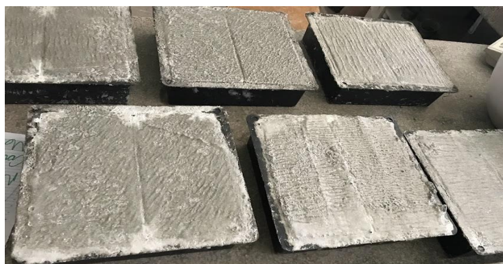
Figura 15 – Blocos em moldes de plástico na produção manual.
