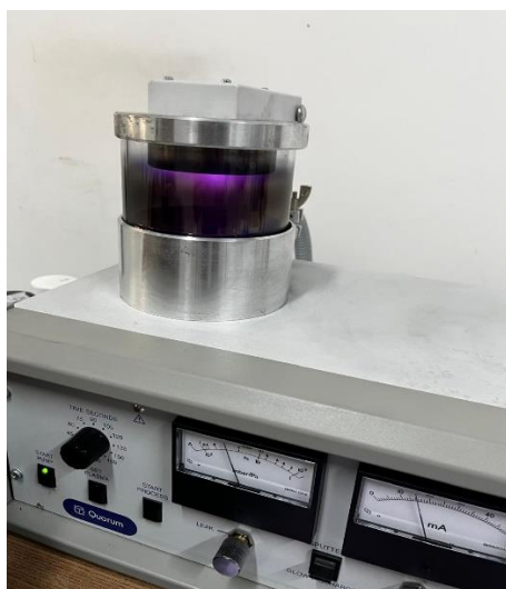
Figura 21 – Processo de metalização com ouro e paládio
