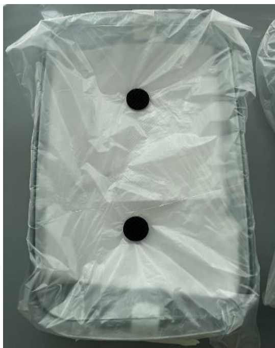
Figura 38 – Adaptação de recipiente para coletor de resíduos na fase de descongelamento
