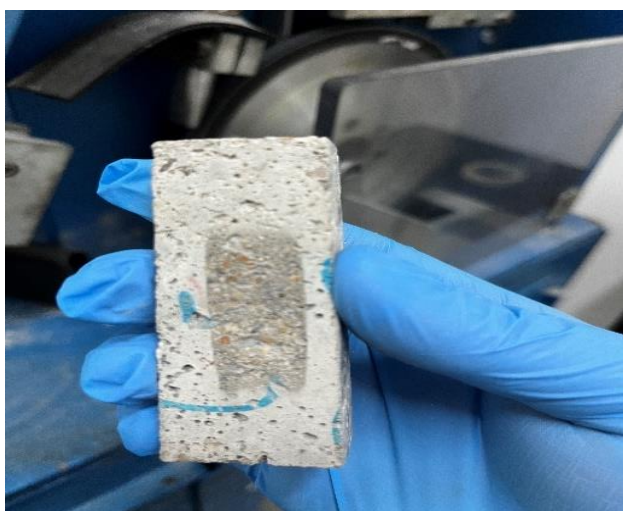
Figura 34 – Amostra após realização do ensaio de abrasão
