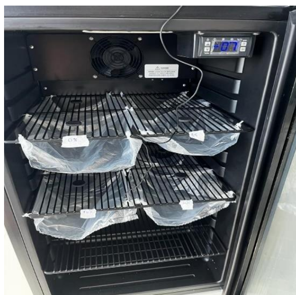
Figura 37 – Adaptação de coletor de resíduos na fase de congelamento
