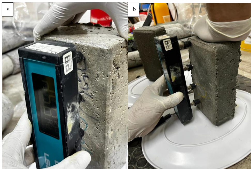
Figura 46 – Ensaio de resistividade a) Bloco produzido manualmente; b) Bloco produzido em larga escala
