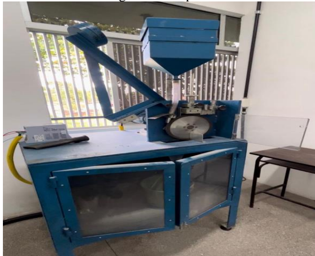
Figura 30 – Equipamento de abrasão com ligação do bico ao recipiente de armazenamento, por mangueira transparente
