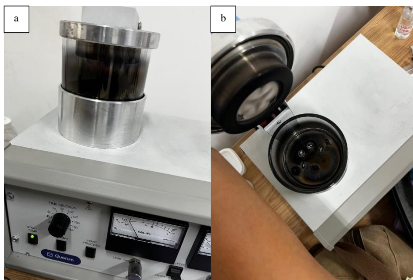
Figura 20 – Equipamento do processo de vácuo a) Metalizador; b) Amostras
