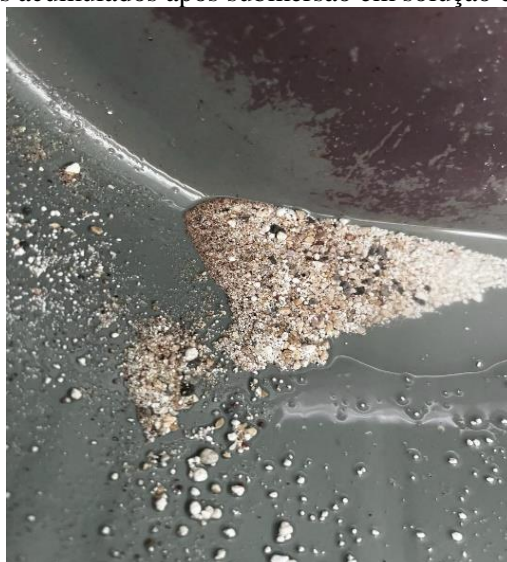
Figura 44 – Resíduos acumulados após submersão em solução de hidróxido de cálcio
