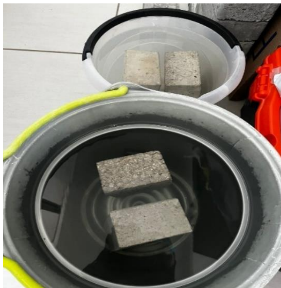
Figura 36 – Submersão das amostras em solução teste por 24 horas
