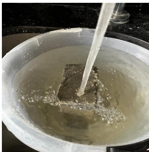
Figura 40 – Submersão dos blocos intertravados de concreto, para lavagem em água corrente
