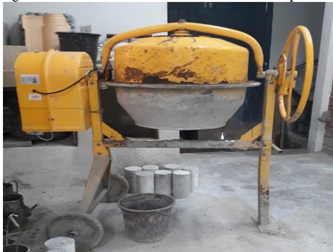
Figura 14 – Misturador mecânico com 120L de capacidade
