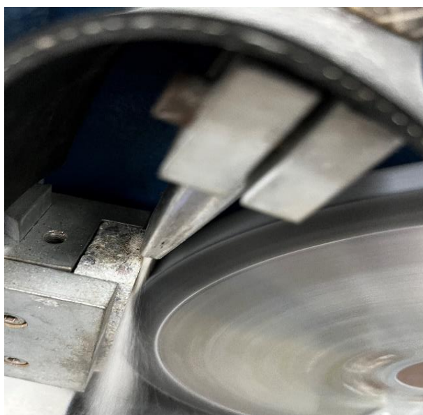
Figura 29 – Bico de areia projetando abrasivo tangencialmente à amostra
