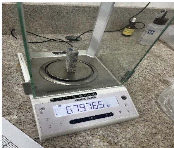
Figura 33 – Pesagem da amostra com balança de precisão de 0,0001g
