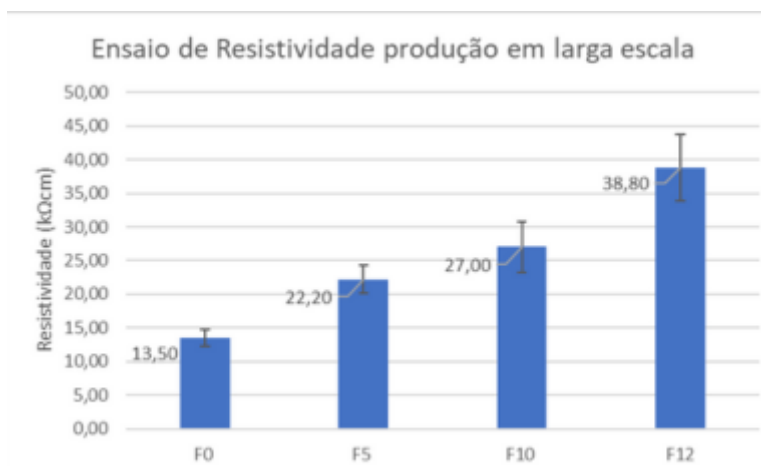
Figura 54 – Média e desvio padrão da resistividade do bloco produzido em larga escala
