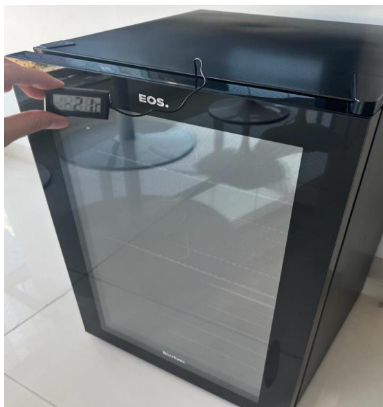
Figura 35 – Cervejeira para ensaio de congelamento e descongelamento
