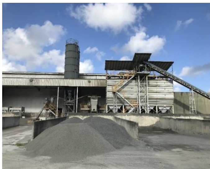
Figura 13 – Área de armazenamento de componentes do bloco de concreto na fábrica da Concrepoxi Artefatos.
