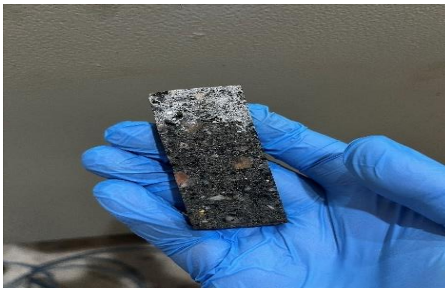
Figura 32 – Secagem com jato de ar comprimido após lavagem ultrassônica
