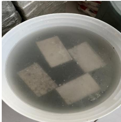
Figura 43 – Blocos submersos em solução de hidróxido de cálcio
