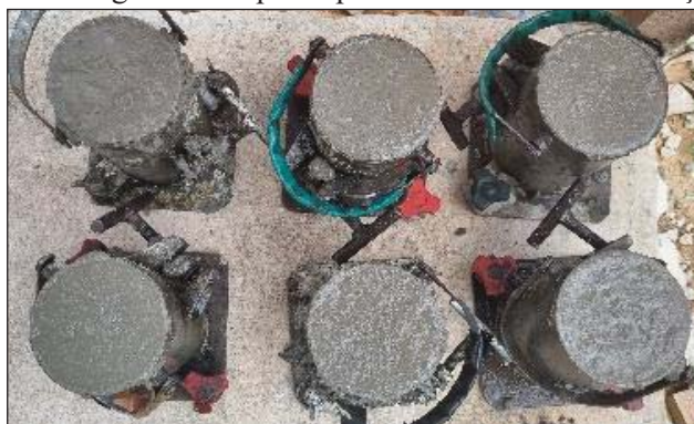
Figura 26 – Moldagem de corpo de prova do concreto no reforço estrutural.
