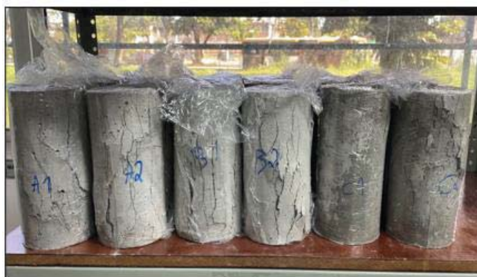
Figura 29 – Corpos de prova rompidos por teste de resistência mecânica à compressão
