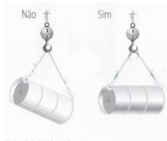
Figura 15 – modos de içamento de cargas
