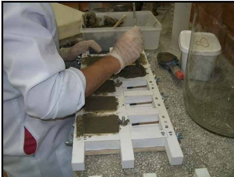
Foto 5.10 – Moldagem dos corpos de prova.
