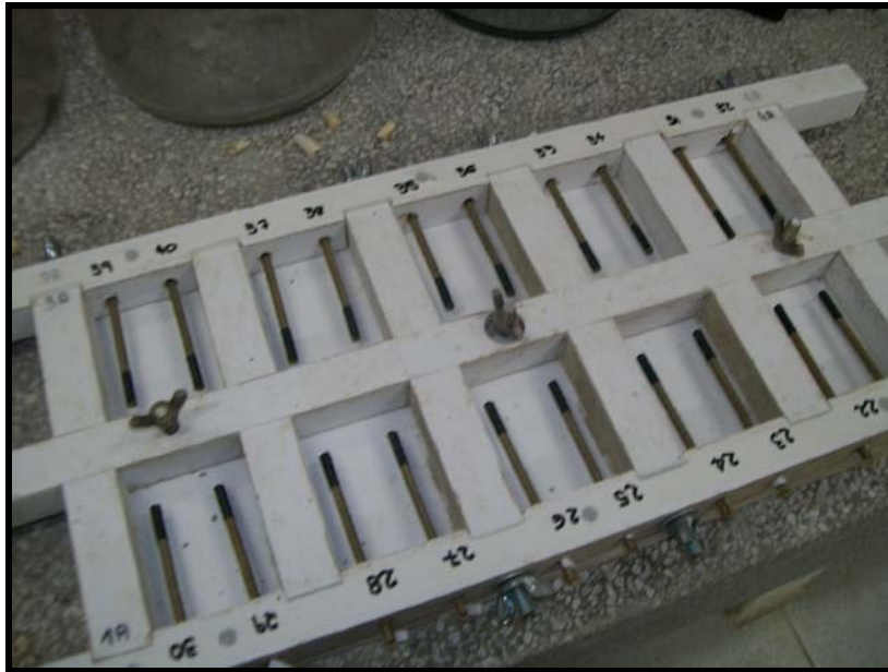
Foto 5.9 – Forma de madeira e distribuição das armaduras.
