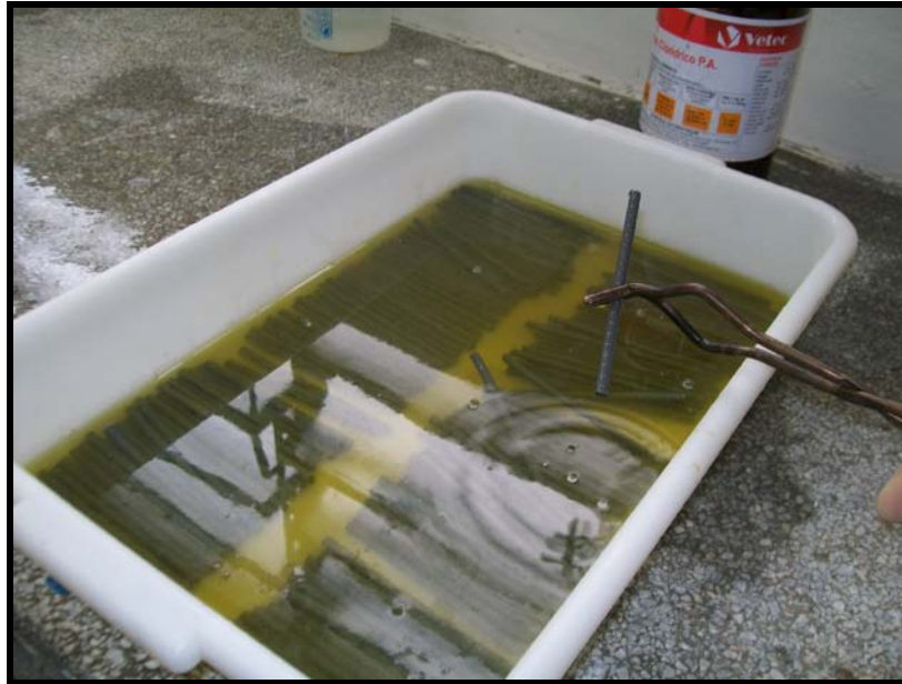
Foto 5.3 - Imersão da barra na solução de ácido clorídrico e hexametilenotetramina.
