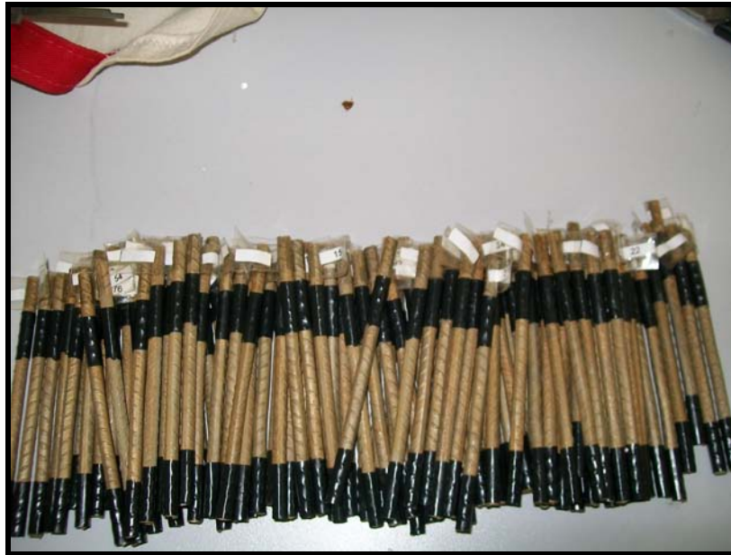
Foto 5.7 – Delimitação da área de exposição das armaduras.
