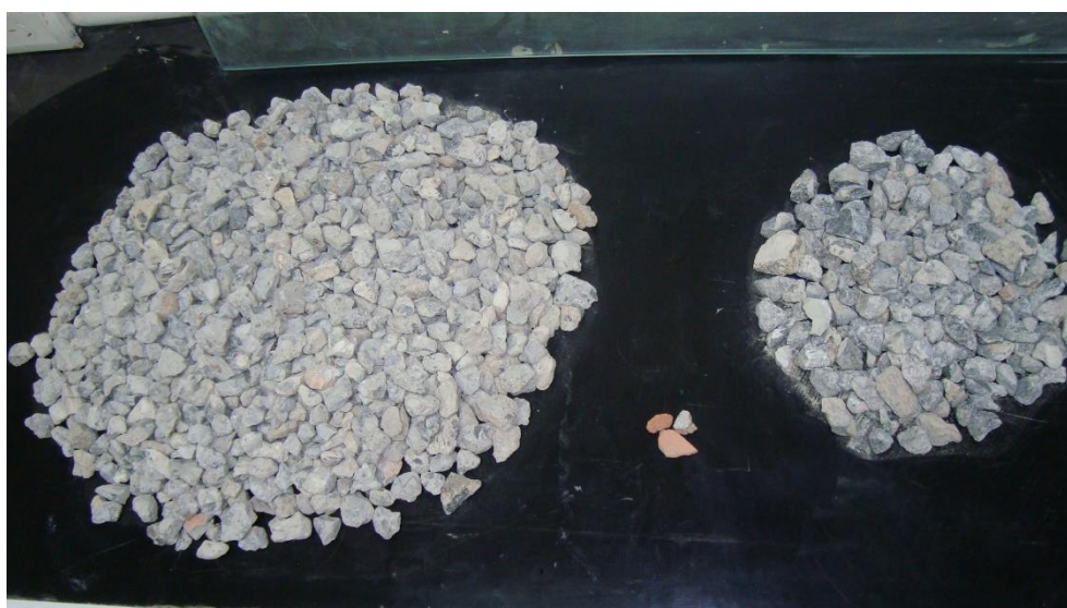
Figura 17 - Separação tátil-visual de material pós-beneficiado
