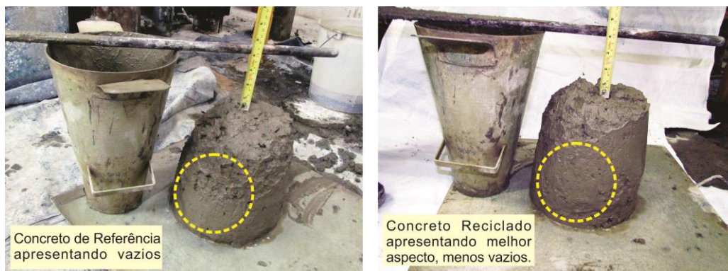
Figura 38 - Aspecto visual geral do concreto de referência e do reciclado com 100% de substituição.
