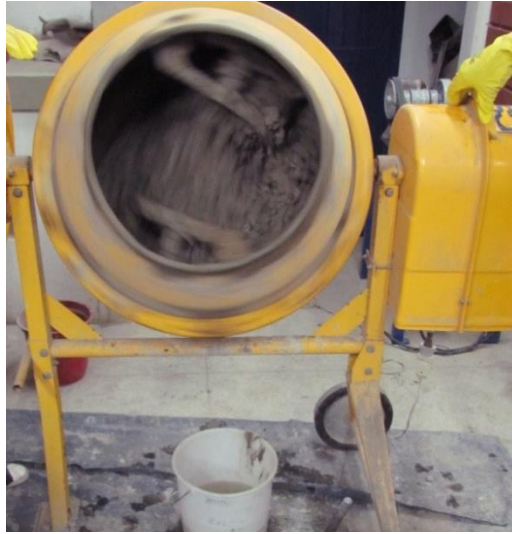
Figura 24 - Betoneira com materiais inseridos para mistura do concreto.
