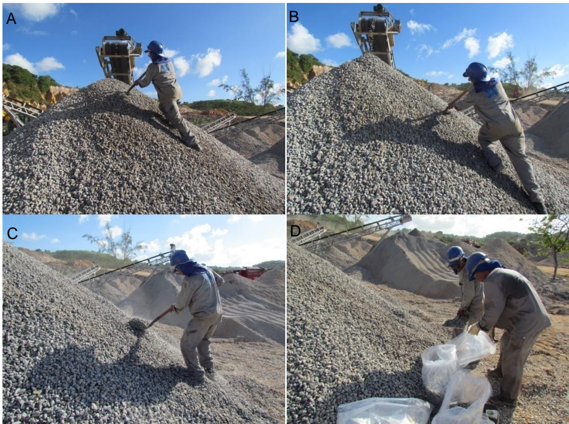
Figura 12 - Coleta do agregado graúdo de RCC realizada no cume (a), no centro (b) e na base (c) da pilha processada e, em seguida, acondicionado em sacos plásticos (d).
