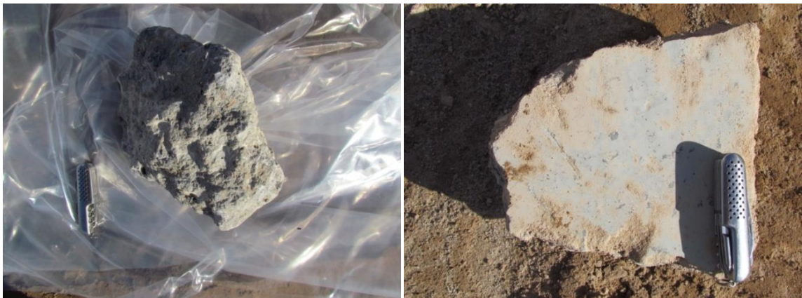
Figura 16 - Material coletado da amostra pré-britagem, oriundo das placas da Avenida Caxangá, Recife-PE.
