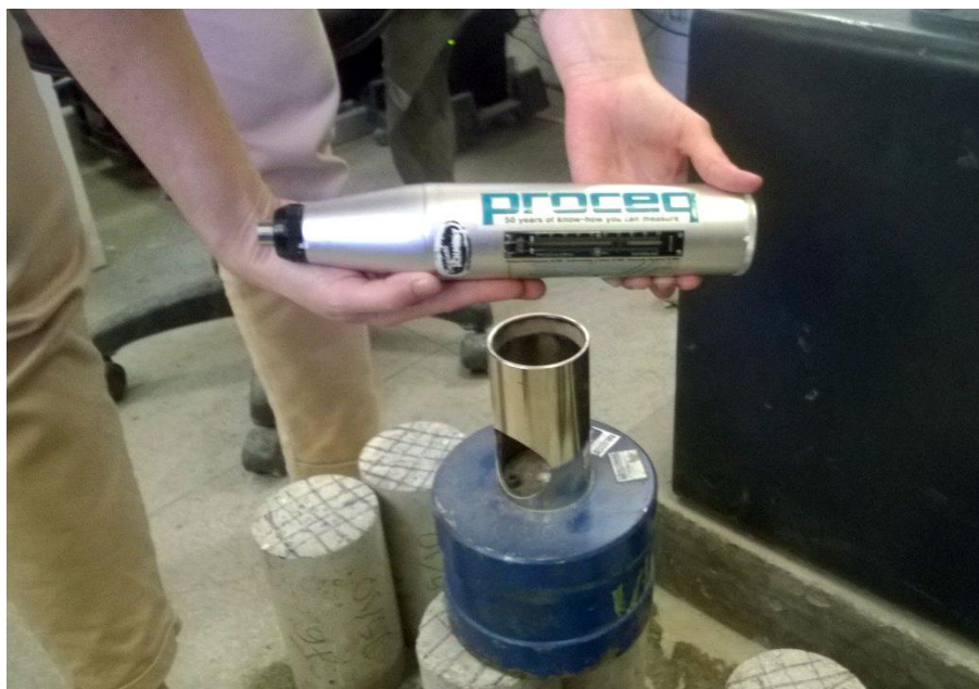
Figura 32 - Equipamentos necessários para o ensaio de esclerometria.
