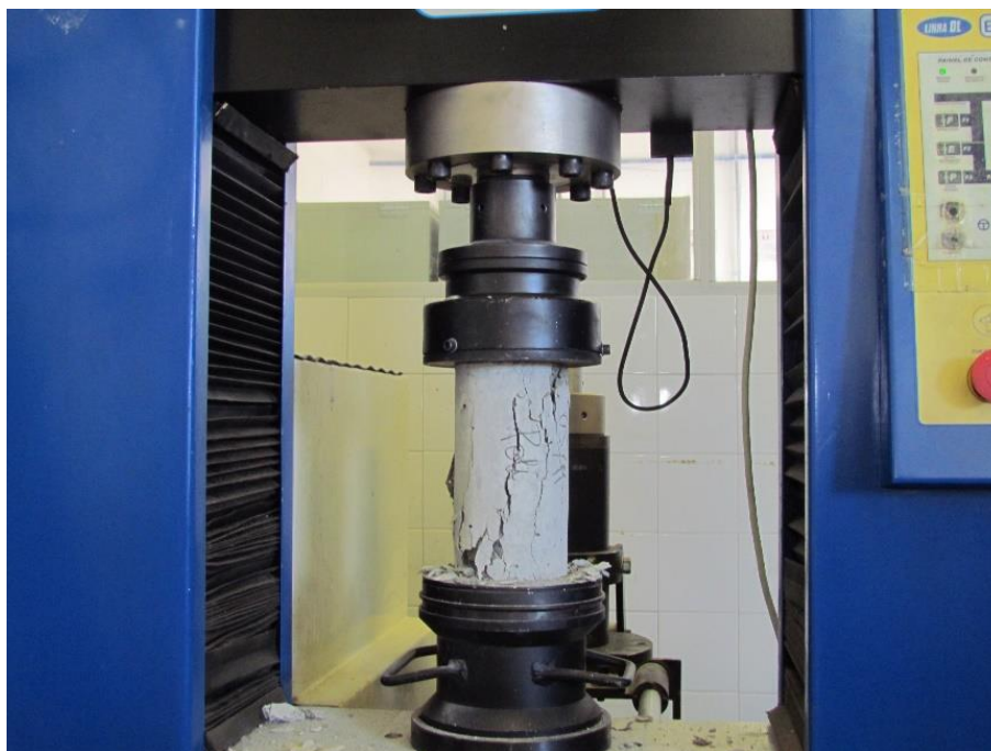
Figura 28 - Rompimento de corpo de prova
