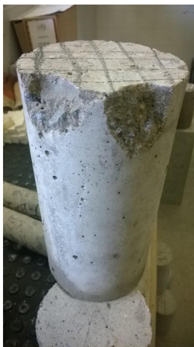
Figura 33 - Dano ocasionado no corpo de prova durante a realização do ensaio de esclerometria.
