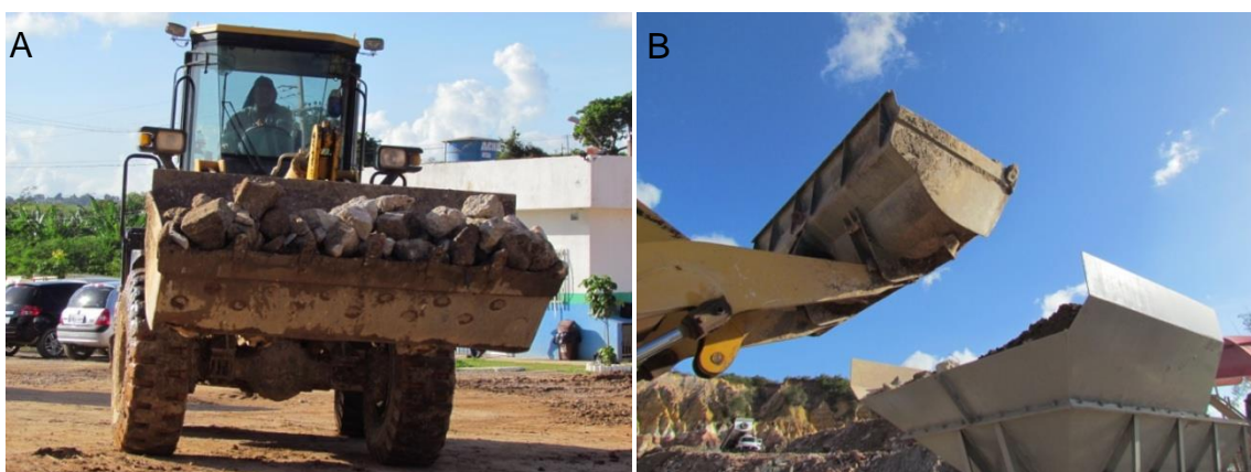
Figura 10 - Transporte (a) e despejo (b) do material no britador realizado por meio de trator.
