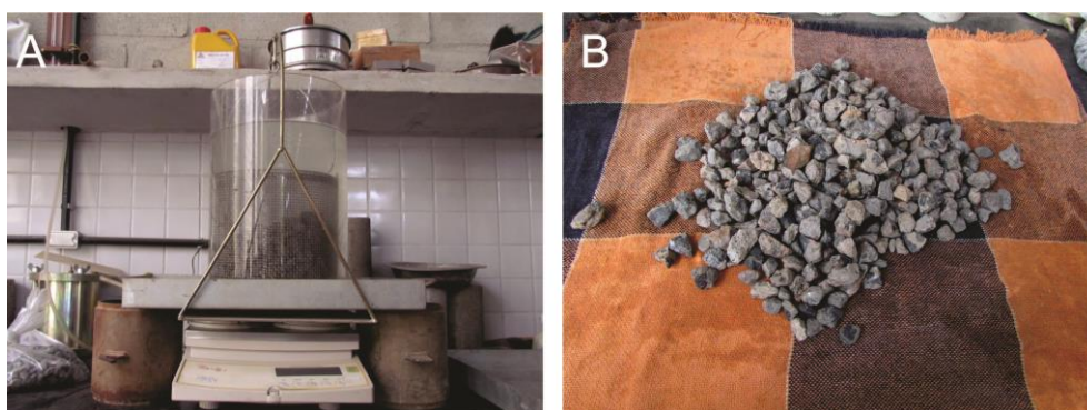
Figura 22 - Ensaio de absorção de água e massa específica do agregado graúdo
