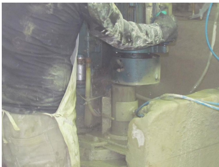
Figura 27 - Retificação dos corpos de prova.
