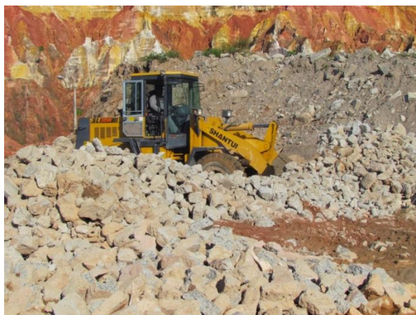
Figura 10 - Transporte (a) e despejo (b) do material no britador realizado por meio de trator.
