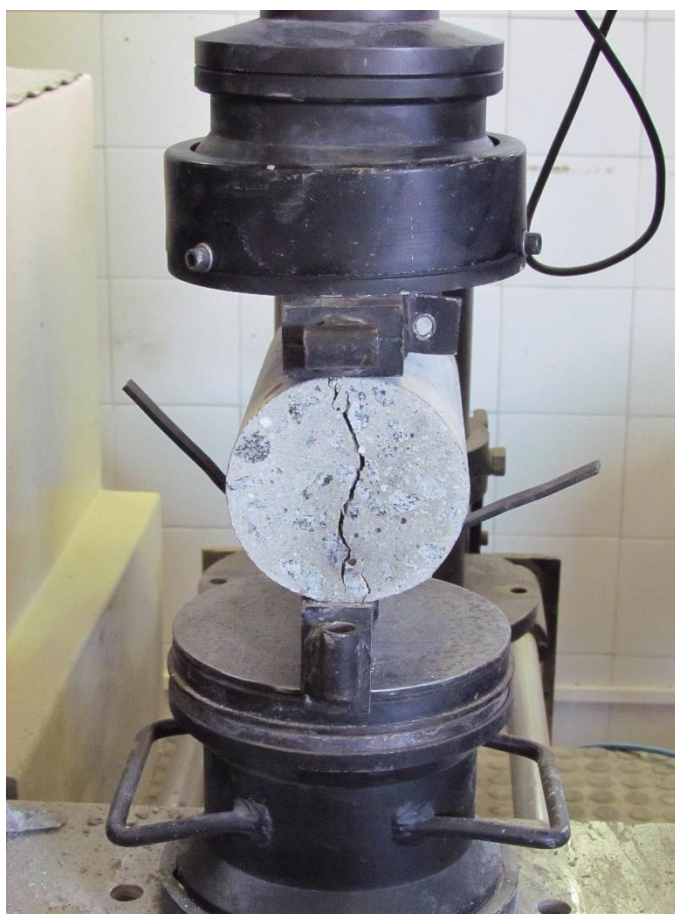
Figura 29 - Ensaio de resistência à tração por compressão diametral.
