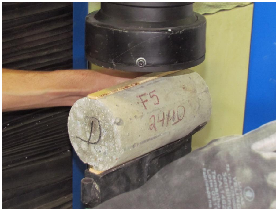
Figura 30 - Tiras de madeira com mesmo comprimento do Corpo-de-Prova.
