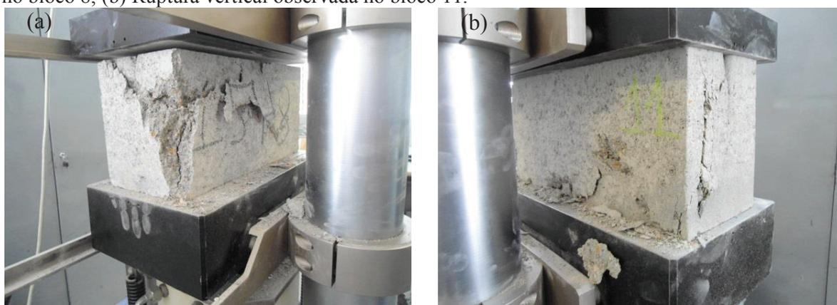
A tendência dos blocos da família BR50 ruptura se apresentou semelhante ao caso observado em BR30, com escamação das paredes externas e ruptura na vertical. Foram observadas fraturas maiores que as presentes nas famílias dos blocos rompidos anteriormente, o que pode ser relacionado ao aumento do teor de finos na mistura (Figura 40).
