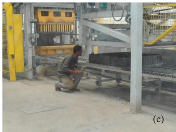
Contudo, a fim de evitar necessidade de ajustes a cada produção, a umidade ótima foi ajustada para a produção dos blocos BC e repetido para as demais famílias. O teor de água ideal foi de 8,28%, correspondente a 83,2 L de água a cada família de blocos produzida. O concreto foi transportado por uma esteira até a vibroprensa que é capaz de produzir 24 (dezesesseis) blocos por ciclo.
