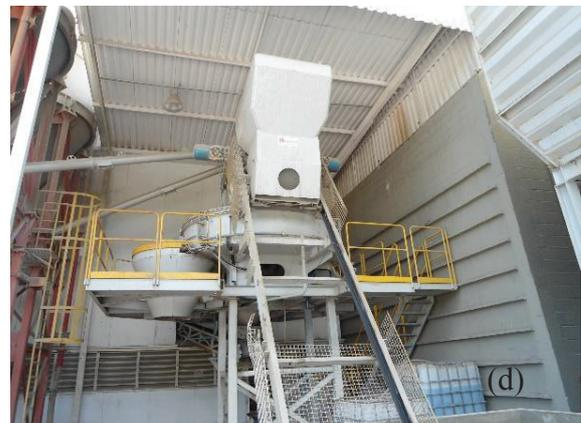
Os materiais pesados foram colocados em um recipiente de forma aleatória, para enfim, serem colocados no misturador. Buttler (2007) afirma que a ordem de lançamento dos materiais no misturador não tem muita interferência no concreto.
