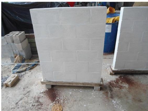
A câmara térmica é uma edificação constituída de duas salas onde uma delas representa o exterior da edificação, submetendo a parede a ciclos de aquecimento e resfriamento e o outro, o interior. Os ciclos de aquecimento são obtidos por meio de um conjunto com 12 (doze) lâmpadas incandescentes de 150 W e os de resfriamento, por um ar condicionado de 12.000 BTU (Figura 28).
