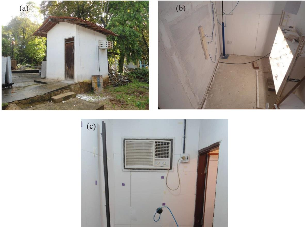
Inicialmente, as paredes de blocos BC e BR100 foram transferidas para a câmara térmica, centralizada na parede de ensaio e todos os espaços não ocupados pela parede foram vedados com isopor e massa acrílica (Figura 29).
