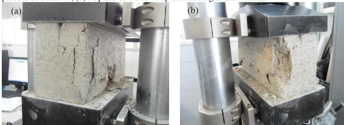
Figura 41 - Ruptura de blocos da Família BR100: (a) Ruptura com tendência horizontal observada no bloco 5; (b) Desplacamento das paredes do bloco após ruptura observado no bloco 9.
