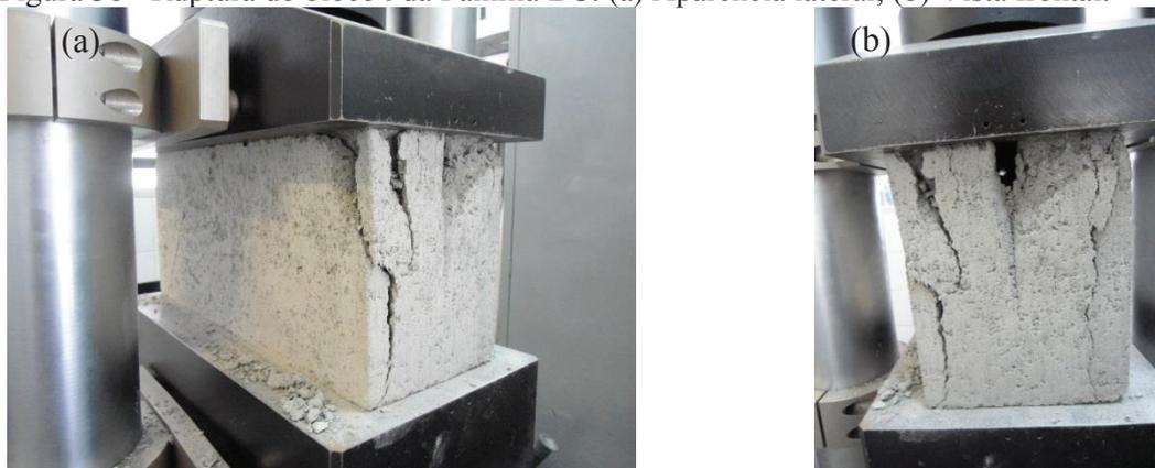
Figura 39 - Ruptura de blocos da Família BR30: (a) Tendência vertical e deslocamento observados no bloco 8; (b) Ruptura vertical observada no bloco 11.
