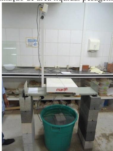
De posse da área líquida dos blocos de concreto foi possível determinar o volume destes e calcular suas massas específicas. A massa específica do bloco seco é igual à massa do bloco
