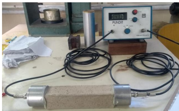
Figura 20 – Propagação de ondas no corpo de prova prismático de argamassa
