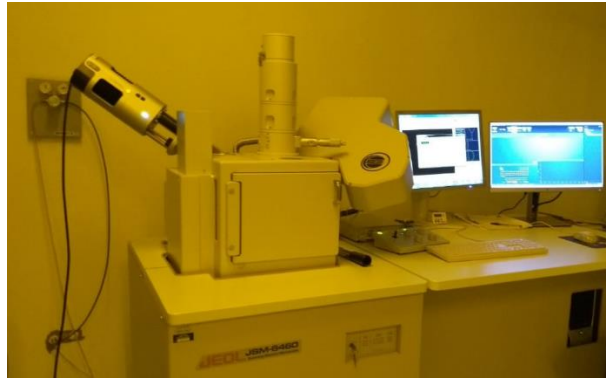
Figura 24 – Equipamento utilizado para observação e registro das eletromicrografias
