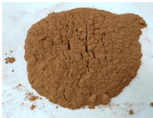
Figura 12 – Cinzas de lodo de esgoto obtidas a 800 °C
