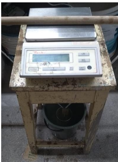
Figura 21 – Esquema montado para obtenção da massa do corpo de prova saturado imerso em água
