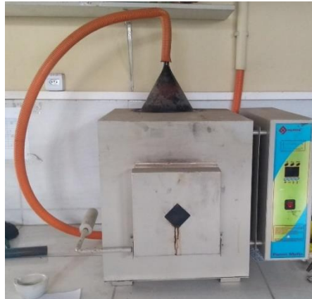
Figura 10 – Forno mufla utilizado na calcinação do lodo
