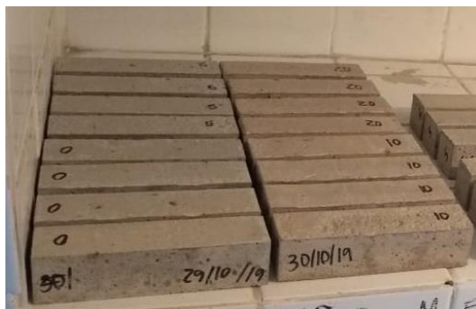
Figura 15 – Corpos de prova prismáticos de referência e com as substituições em massa de 5%, 10% e 20% do cimento por CLE
