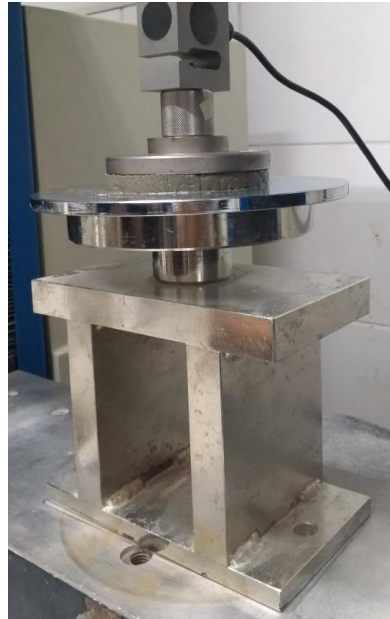
Figura 18 – Disposição das placas metálicas necessárias a realização do squeeze flow
