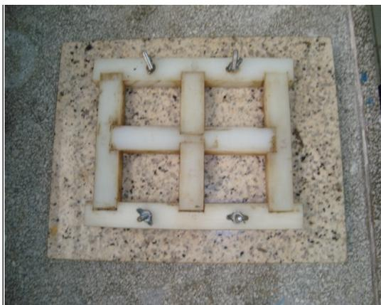
Foto 3.13 – Fôrma utilizada para moldagem dos corpos-de-prova prismáticos.
