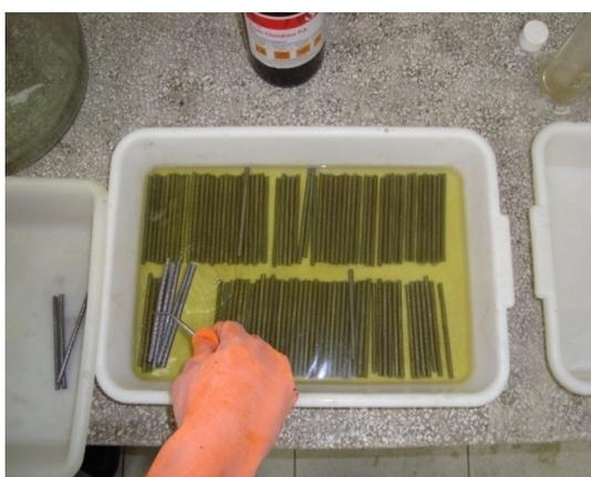
Foto 3.5 - Barras imersas em solução de ácido clorídrico.
