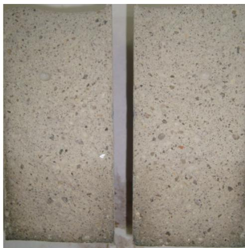
Foto 4.2 – Altura capilar observada em corpo-de-prova com relação água/cimento igual a 0,4
