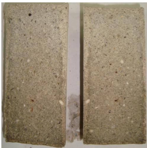
Foto 4.1 – Altura capilar observada em corpo-de-prova com relação água/cimento igual a 0,7
