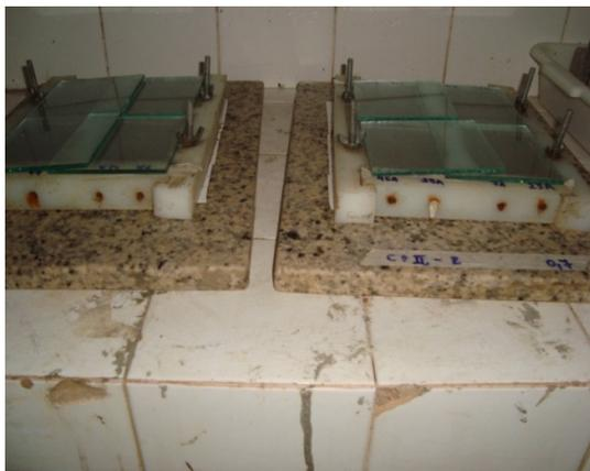
Foto 3.15 – Corpos-de-prova prismáticos ainda nos moldes na câmara úmida.
