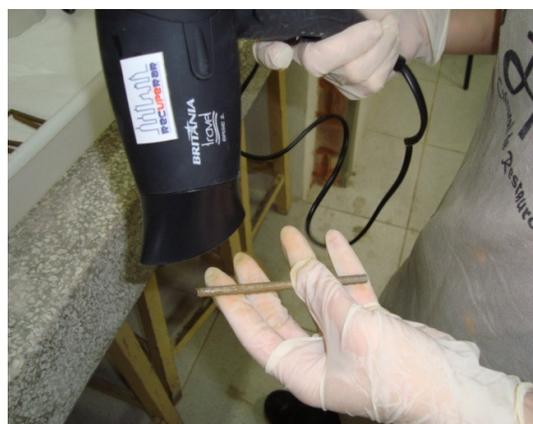
Foto 3.8 – Barra sendo secada com jato de ar quente.
