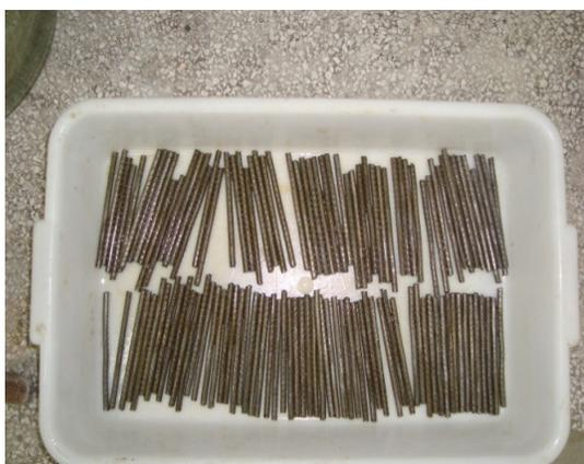
Foto 3.7 – Barras imersas em solução de acetona.
