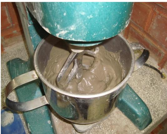
Foto 3.11 – Misturador mecânico utilizado na moldagem dos corpos-de-prova prismáticos.
