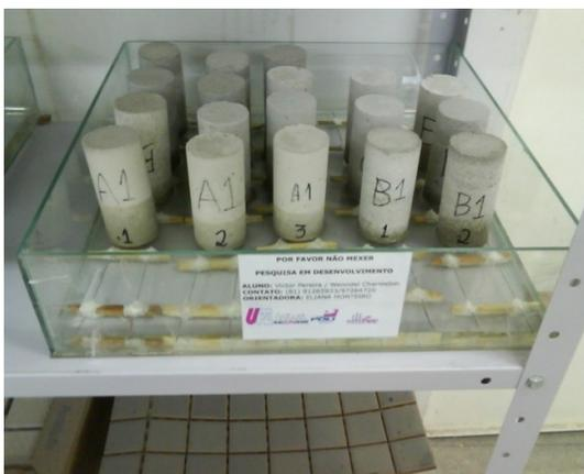
Foto 3.3 – Ensaio de absorção por capilaridade.
