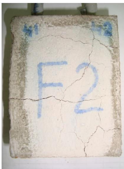
Foto 4.4 – Corpo-de-prova da série F2 (CPIV-32 –  $a/c=0,4$ ) fissurado.
