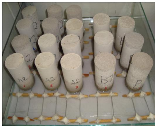
Foto 3.4 – Corpos-de-prova sobre os suportes durante o ensaio de absorção por capilaridade.
