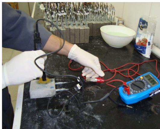
Foto 3.18 – Medição de potencial de corrosão sendo realizada.
