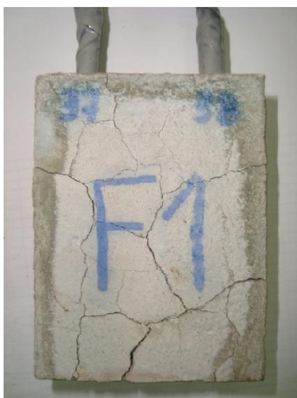
Foto 4.3 – Corpo-de-prova da série F1 (CPIV-32 –  $a/c=0,4$ ) fissurado.
