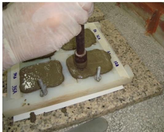
Foto 3.14 – Moldagem dos corpos-de-prova prismáticos.
