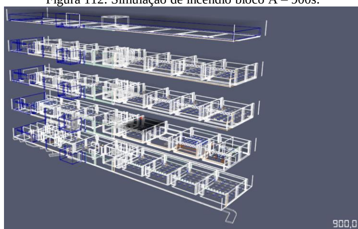
Figura 112: Simulação de incêndio bloco A – 900s.
