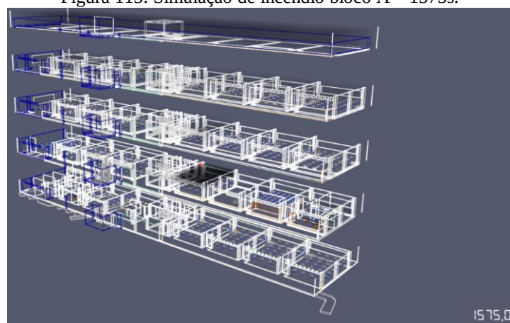
Figura 115: Simulação de incêndio bloco A – 1575s.
