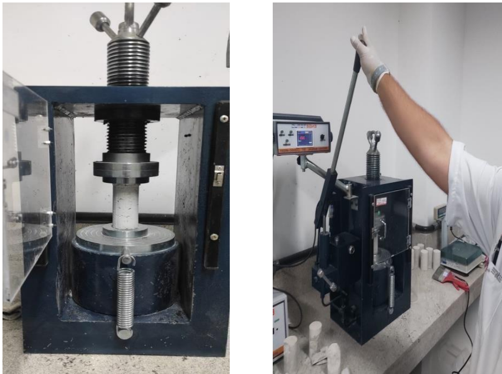
Figura 13. Ensaio de resistência a compressão em um dos corpos de prova de argamassa da tração com substituição de 5% da cal hidratada CHI.
