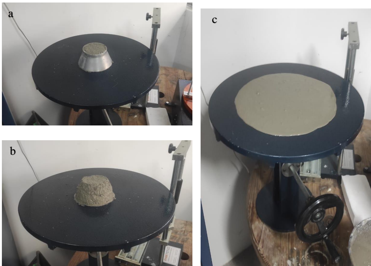
Figura 11. Realização de ensaio de argamassa em estado fresco. Flow table .
