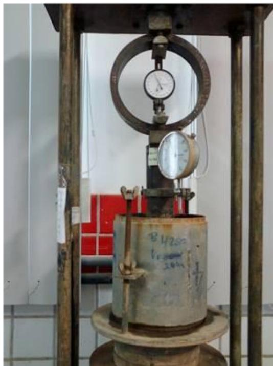
Figura 29 – Resistência à penetração do ensaio de ISC.
