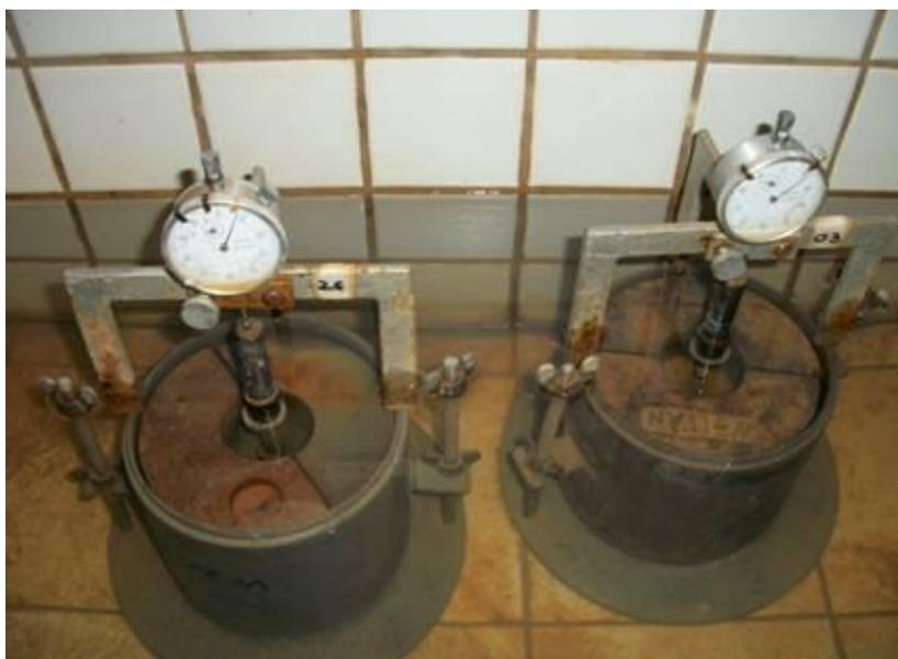
Figura 28 – Corpos de prova submersos por 4 dias para determinação da expansão.
