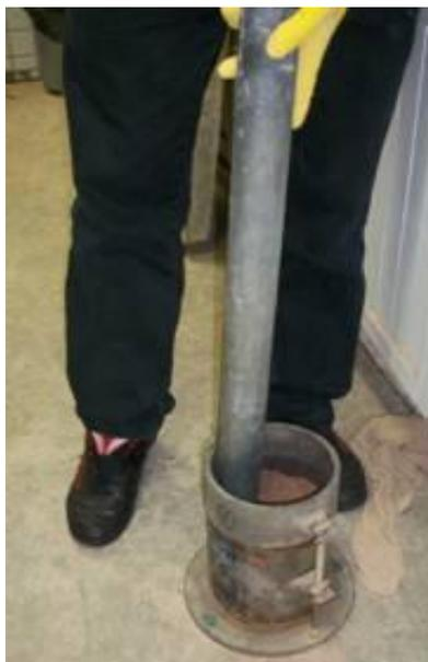
Figura 27 – Moldagem do corpo de prova.
