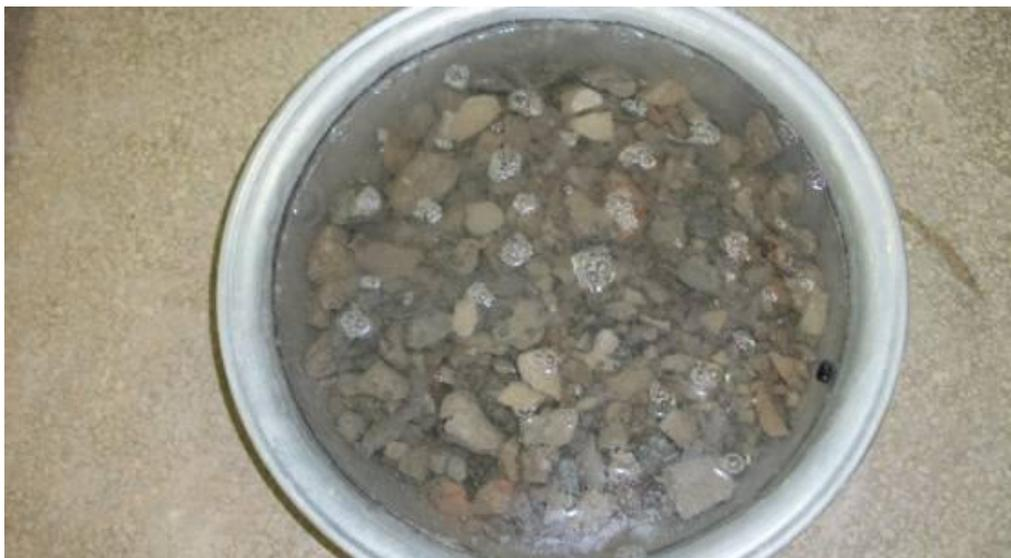
Figura 21 – Ensaio de absorção do agregado reciclado.
