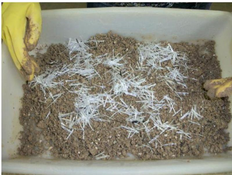
Figura 26 – Fibra adicionada à mistura homogeneizada.
