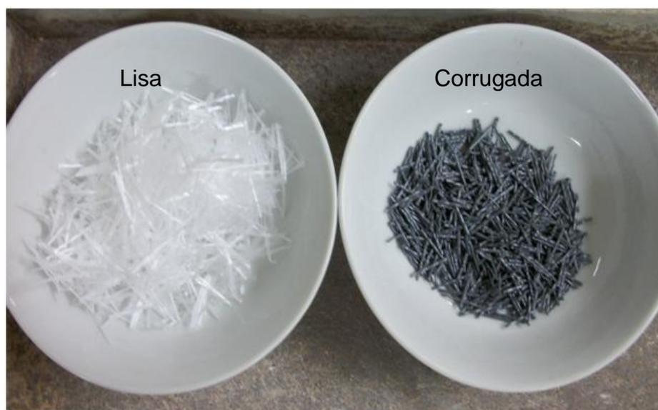
Figura 14 – Fibras de polipropileno (lisa e corrugada).
