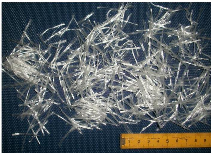
Figura 15 – Fibras de polipropileno.
