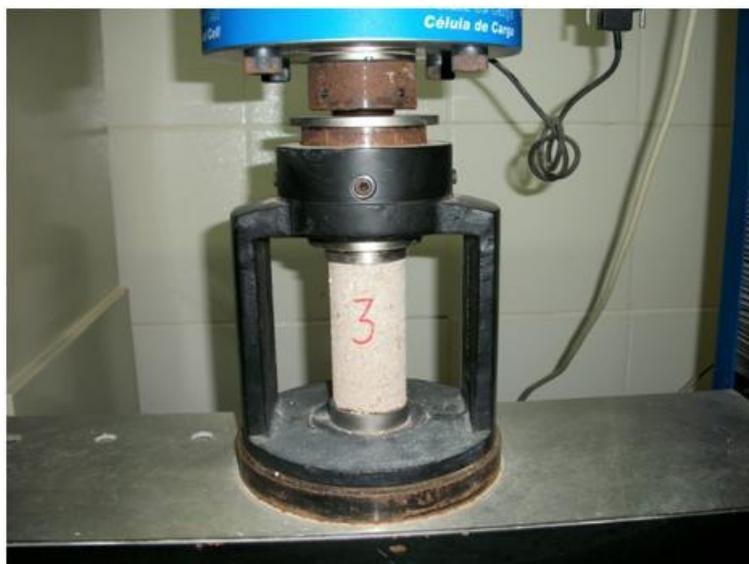
Figura 32 – Ruptura do corpo de prova.
