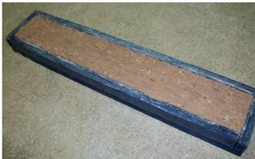
Figura 24 – Realização do ensaio de retração.
