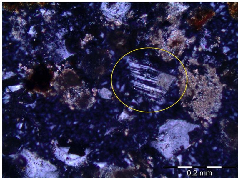
Figura 41 – Agregado reciclado com evidência de feldspato (microclina).
