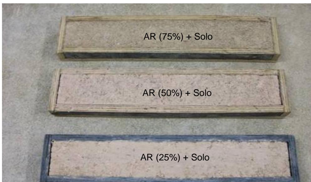
Figura 36 – Verificação da retração linear para cada mistura.
