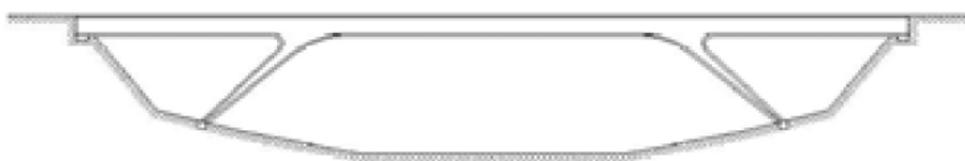
Figura 2.13 – Seção longitudinal de ponte em pórtico (PINHO; BELLEI, 2007).
