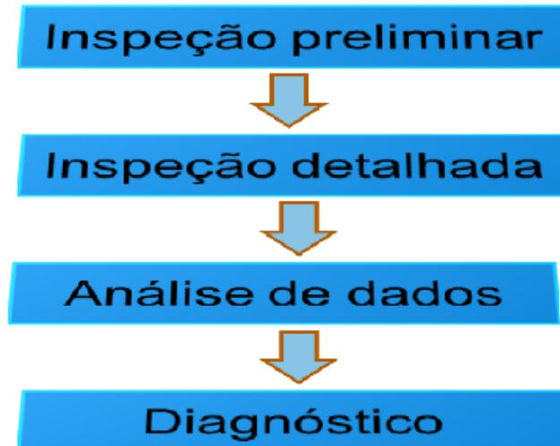
Figura 3.1 - Fluxograma das atividades de inspeção nas pontes.
