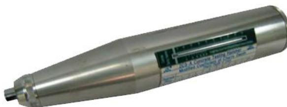
Fotografia 2.4 - Esclerômetro de impacto Schmidt – modelo N (SOLOCAP, 2013).
