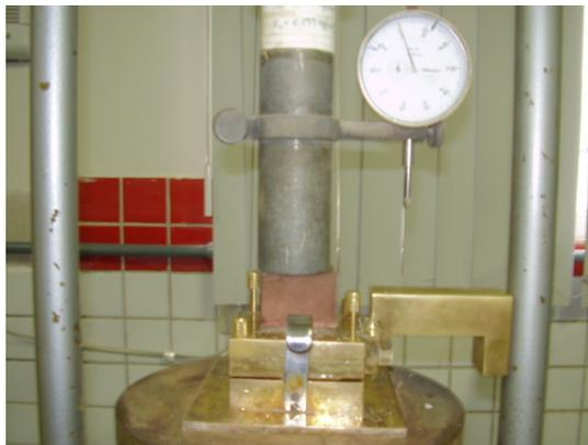
**Figura 3.40** – Compactação estática na prensa de CBR.
