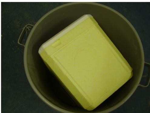
**Figura 3.37** – Vista superior do tambor de 200 L para acondicionamento de amostras.
