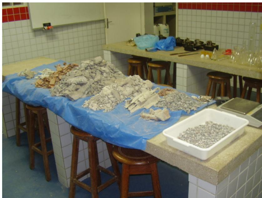
**Figura 3.14** – Segregação de amostra de RCD (Fase 2).
