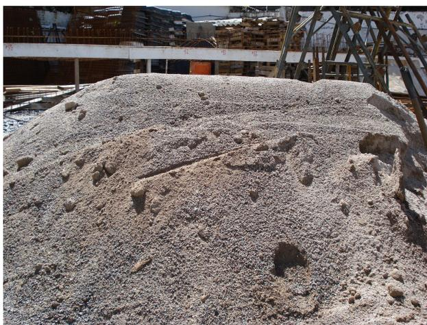
**Figura 3.23** – RCD britado e peneirado.
