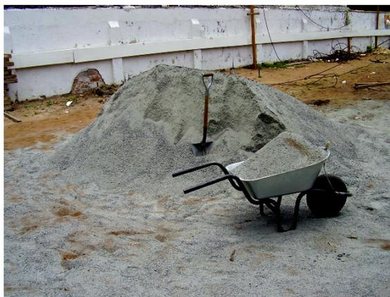
**Figura 3.9** – Coleta de amostra de pó-de-pedra.
