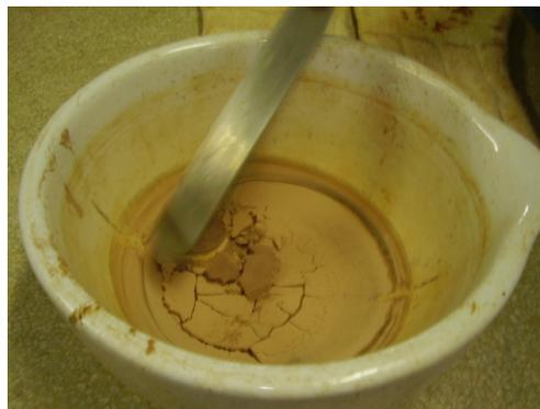
**Figura 3.25** – Extração de amostras após retirada de estufa.
