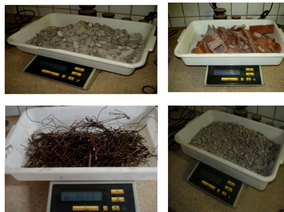
**Figura 3.13** – Pesagem dos constituintes de cada amostra (Fase 1).
