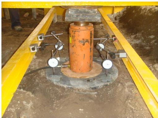
**Figura 3.66** – Deflectômetros posicionados.
