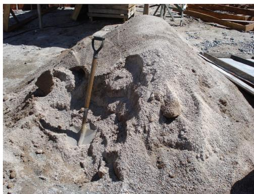
**Figura 3.49** – Aspecto de pilha de RCD.
