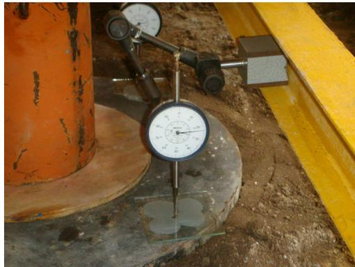
**Figura 3.67** – Detalhe de um deflectômetro.
