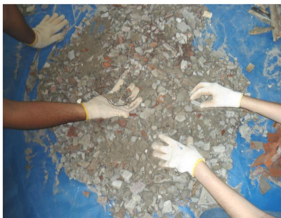
**Figura 3.12** – Segregação tátil-visual de amostra de RCD (Fase 1).
