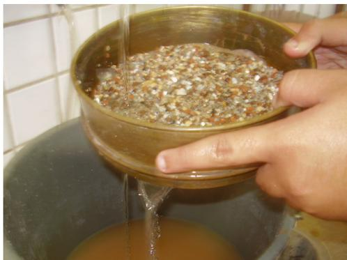
**Figura 3.24** – Preparação das amostras para ensaio de microscopia ótica.
