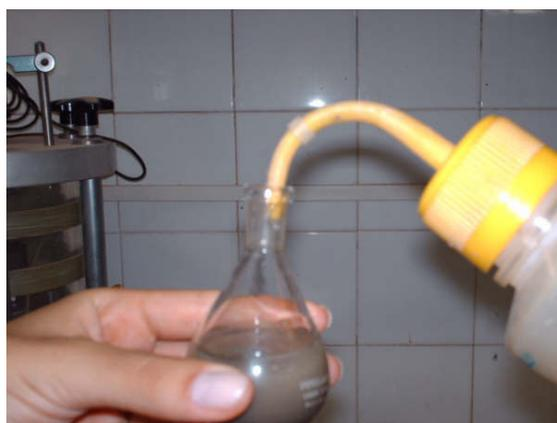
**Figura 3.28** – Utilização de picnômetro no ensaio de densidade real.
