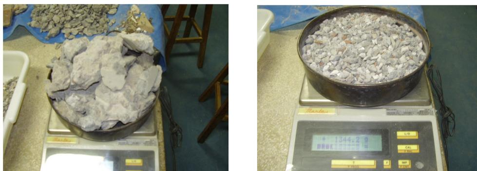
**Figura 3.15** – Pesagem dos constituintes de cada amostra (Fase 2).
