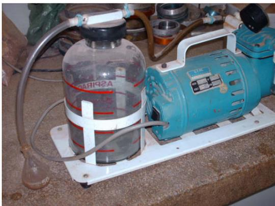
**Figura 3.29** – Utilização de bomba a vácuo.
