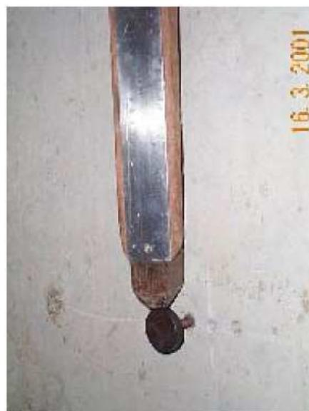
**Figura 2.11** – Detalhe da mira apoiada no elemento macho do pino (GUSMÃO, 2006)
