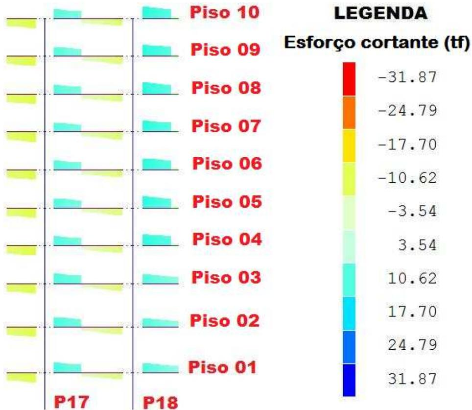
Figura 5.93 – Diagramas de esforço cortante da viga V12 do cenário C4 (01/04/1993)
