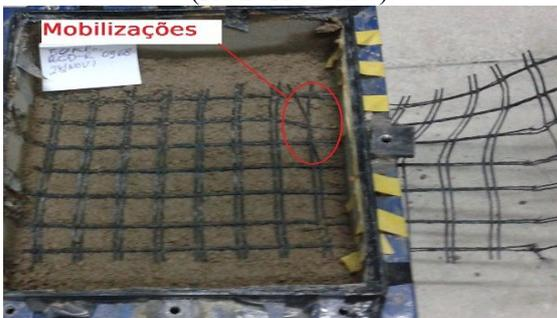
Figura 69: Rompimento da geogrelha (RCD-R 50 kPa).
