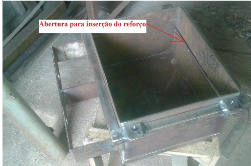
Figura 37: Caixa de arrancamento com dimensões.
