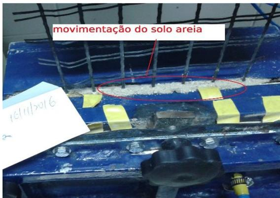
Figura 74: Deformação da geogrelha (Areia 25 kPa).
