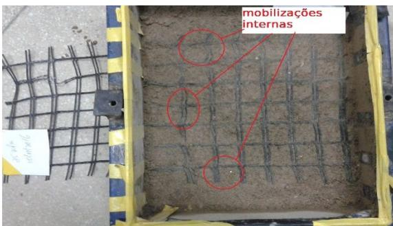
Figura 67: Rompimento da geogrelha (RCD-R 25 kPa).
