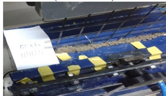
Já no ensaio de arrancamento com a tensão normal de 100 kPa, o RCD-R não permitiu o deslocamento da geogrelha, funcionando, assim, como uma “garra”, causando o rompimento da geogrelha no seu trecho localizado fora da caixa de ensaio (Figura 70).
