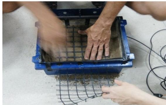
e) Realização dos ensaios: após os procedimentos anteriormente adotados, seguiu-se a realização do ensaio com o material compactado, geogrelha inserida, e topo da caixa protegida com a membrana de PVC (Figura 53), com o devido fechamento da tampa com os parafusos (Figura 54).
