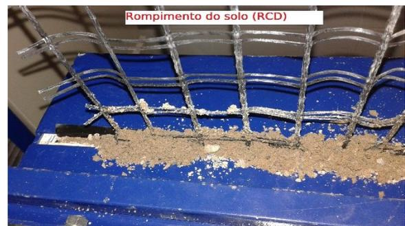
Figura 68: Exumação da geogrelha (RCD-R 50 kPa).
