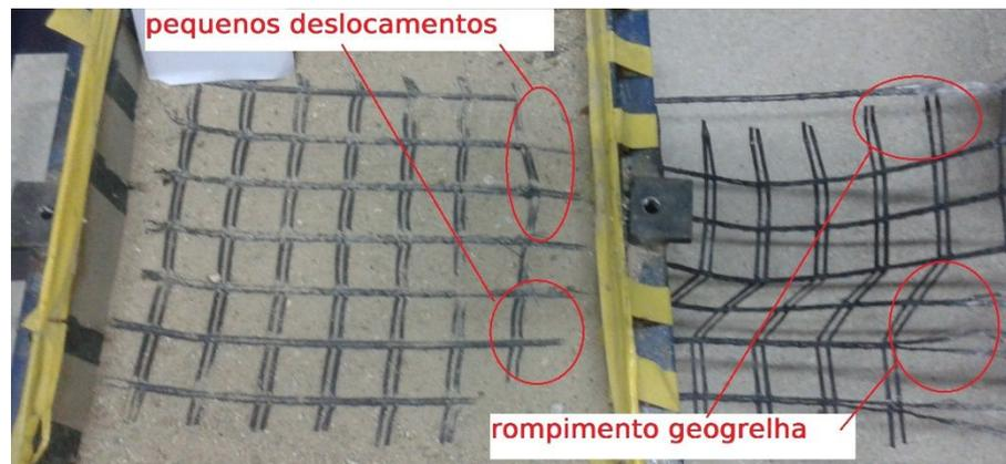
Na condição de pressão normal de 100 kPa (Figura 76), não há indicativo nenhum de movimentação interna que demonstre o rompimento do material de preenchimento (areia). Em todos os testes, nestas condições, a geogrelha sempre se rompeu sem afetar a parte confinada. A areia grossa funcionou como boa ancoragem, o suficiente para suportar o máximo de resistência que a geogrelha pode oferecer à solicitação de tração.
