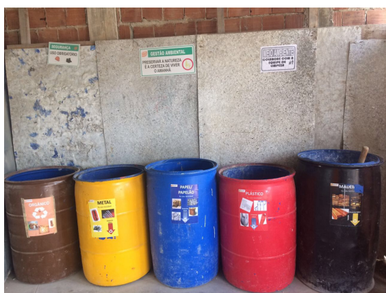
Figura 5.27: Bombonas plásticas para acondicionamento por classe de RCC
