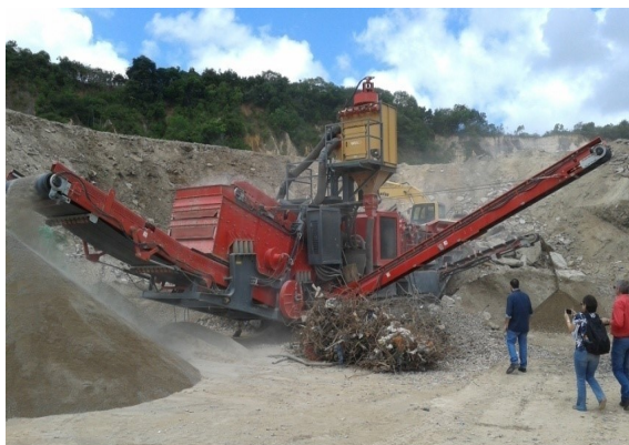
Figura 5.31: Planta para britagem de agregados para construção civil
