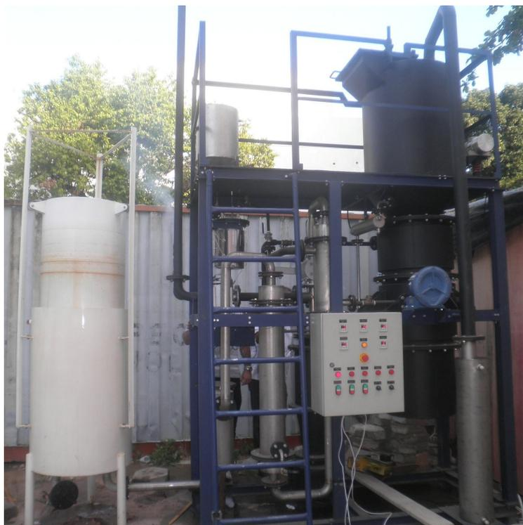
Figura 34 – Gaseificador downdraft ventilado.
