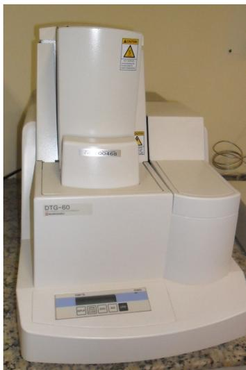
Figura 27 – Balança termogravimétrica, SHIMADZU, modelo DTG-60.
