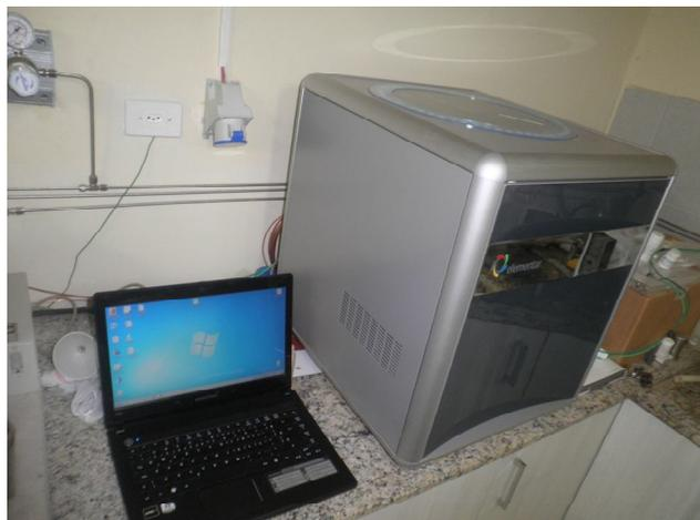
Figura 26 – Analisador elementar CHNOS, ELEMENTAR, modelo Vario EL cube.
