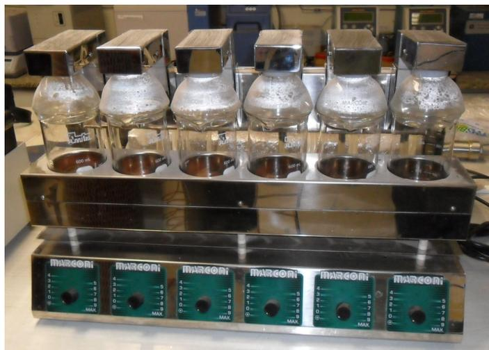
Figura 30 – Digestor para fibra em beckers, MARCONI, modelo MA-450/6.
