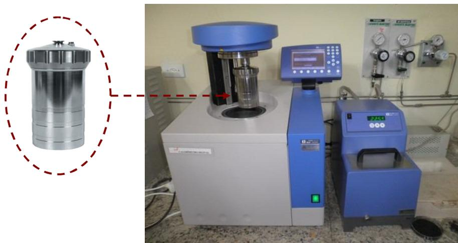
Figura 29 – Calorímetro digital, IKA-WERKE, modelo C2000 Control, com detalhe do vaso de decomposição.
