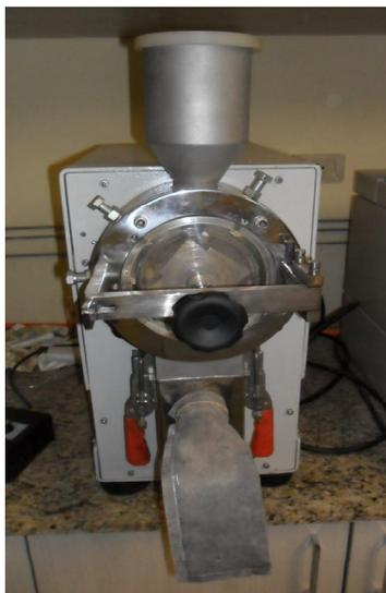
Figura 21 – Micromoinho de facas, MARCONI, modelo MA-048.
