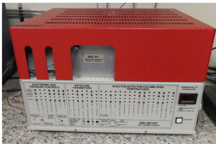
Figura 37 – Cromatógrafo de gás, SRI Instruments, modelo 8610C.
