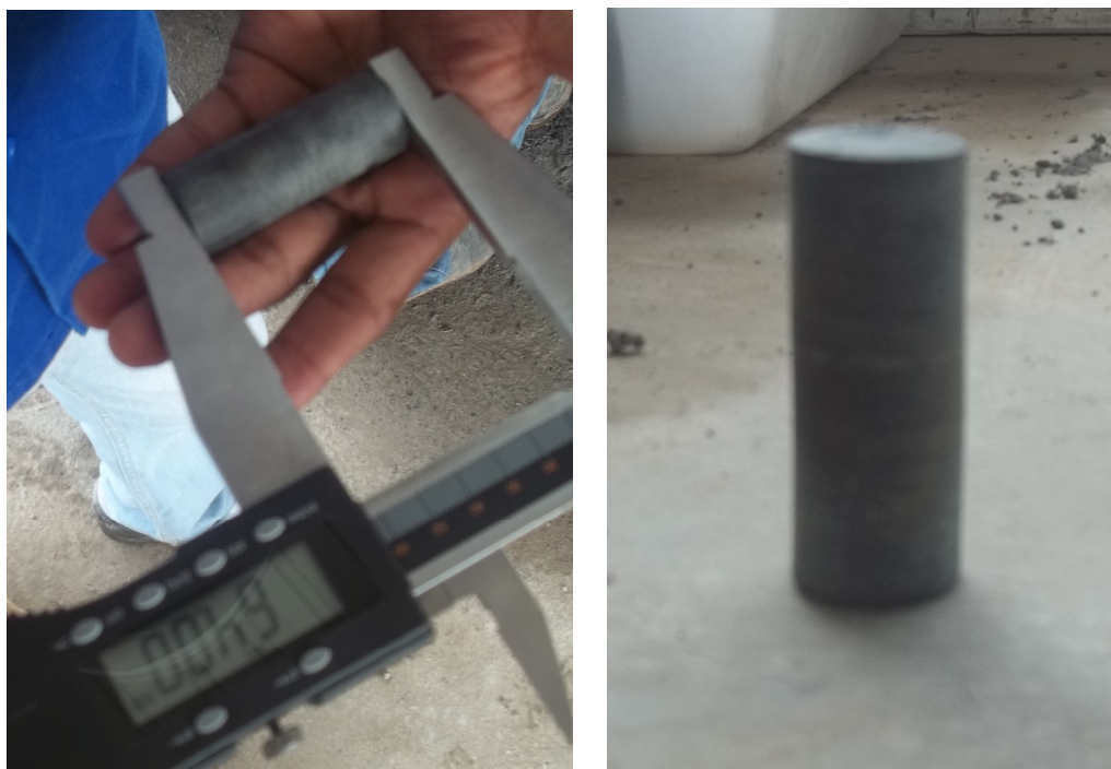
Figura 45 - Amostra de rocha basáltica extraída para ensaio de resistência à compressão simples.
