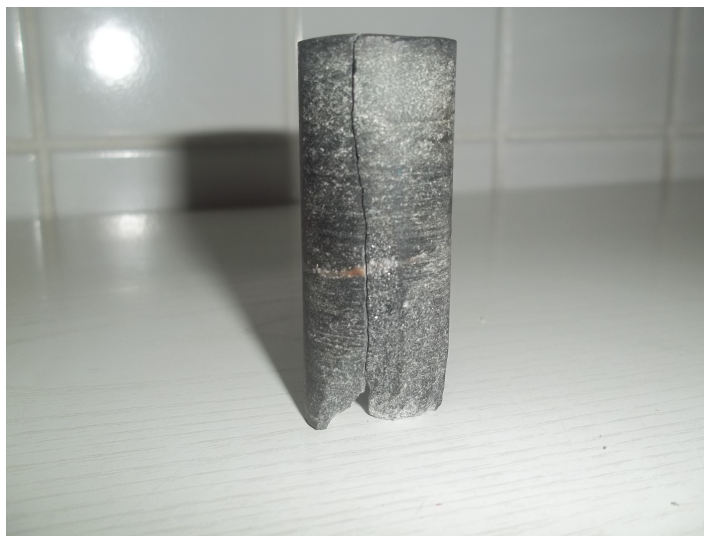
Figura 48 – Amostra 02 de rocha basáltica após rompimento no ensaio de compressão simples
