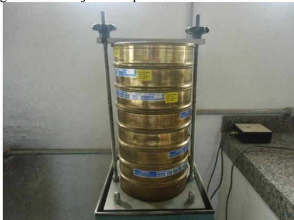
Após a realização de dois ensaios para cada tipo de agregado, adotou-se a média de cada um como a distribuição granulométrica, para depois serem traçadas as curvas granulométricas. Além das curvas, foram obtidas também a dimensão máxima característica (DMC) e o módulo de finura de cada agregado.
