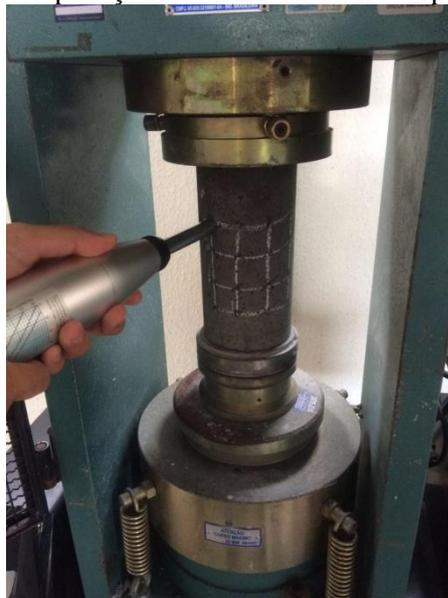
Desta forma, antes de iniciar o ensaio, foram definidos, em cada corpo de prova, os pontos que seriam submetidos ao ensaio de esclerometria, de acordo com a Figura 33.
