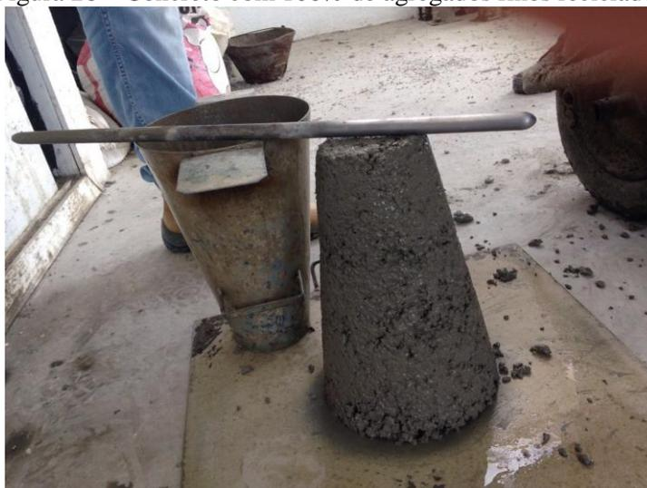
Teve-se então a ideia de utilizar um traço com um concreto seco, que pudesse receber 100% de agregados reciclados. O traço C2, que é utilizado para lajes alveolares, foi então o escolhido para tal.
