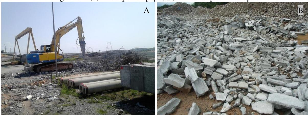
Desde o início da operação da fábrica, os resíduos eram transportados até um pátio na sua parte posterior, e depois amontoados em pilhas, com uma granulometria que só permitia sua utilização em aterros. Deste modo, a fábrica utilizou parte destes resíduos em um aterro para ampliação do terreno de armazenamento dos pré-fabricados, que fica do lado do estacionamento, na parte exterior da fábrica.
