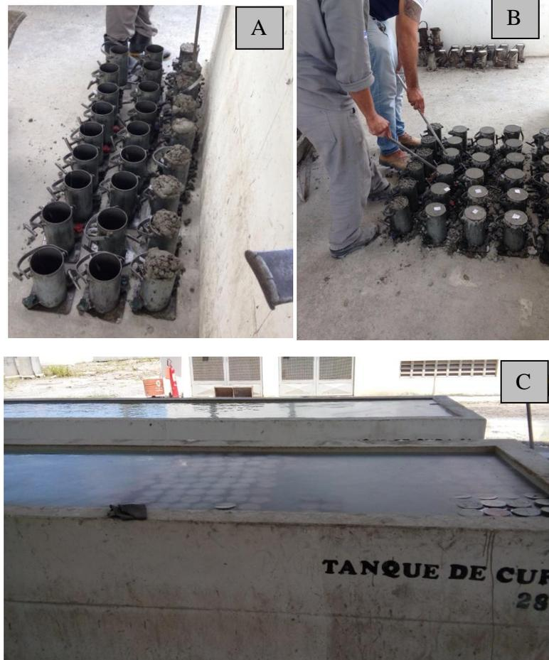
Nos concretos do grupo C2, o procedimento de moldagem dos corpos de prova foi diferente do grupo C1. Com o concreto seco, não seria possível compactar o concreto apenas dando golpes com uma haste, então o procedimento adotado foi colocar o concreto em três camadas, e compactar cada camada com auxílio de um soquete e uma mesa vibratória, tentando chegar o mais próximo possível da compactação obtida no equipamento extrusor (Figura 30).
