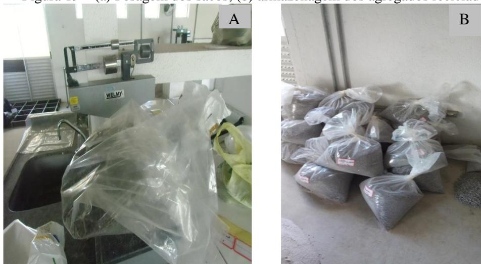
A quantidade total de agregados, em massa, foi calculada em torno de 315 kg para as três granulometrias estudadas. Foram produzidos, ao final, cerca de 500 kg de agregados reciclados. Com essa diferença foi possível a realização de testes preliminares com o concreto e também foi importante para dar margem à segurança, para caso alguma concretagem tivesse sido mal executada, e então o concreto tivesse que ser descartado.
