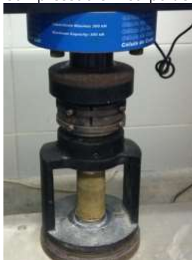
Figura 57: Ensaio de resistência à Compressão em corpo de prova (50x100 mm).
