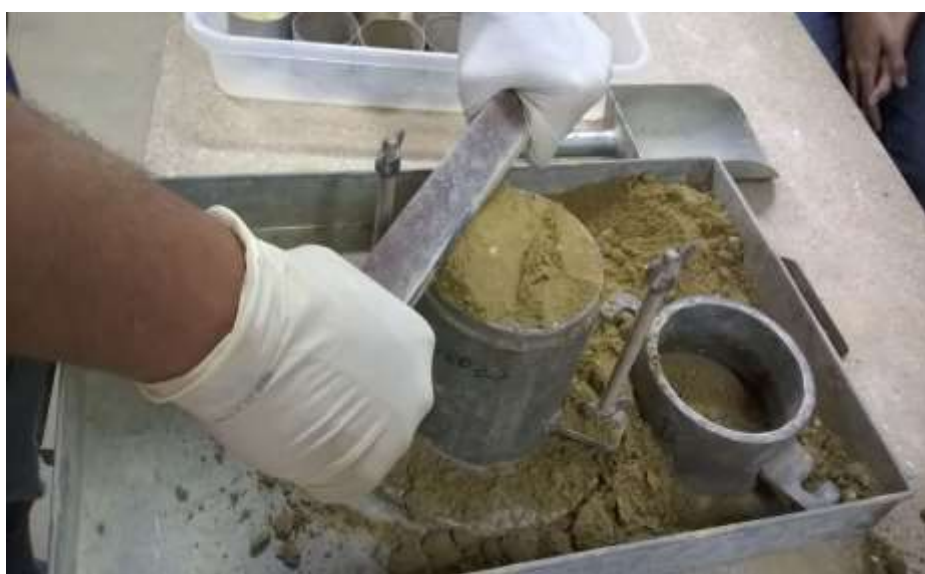
Figura 37: Nivelamento com régua biselada do material excedente.
