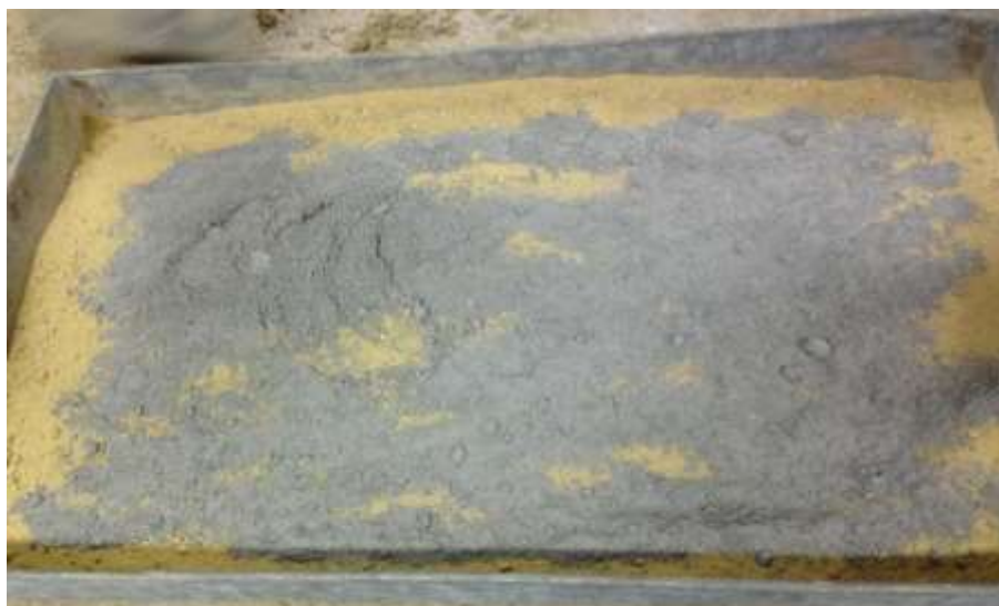
Figura 36: Mistura dos materiais secos (RCC e cimento).
