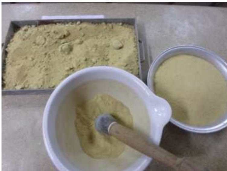
Figura 23: Destorroamento do RCC.
