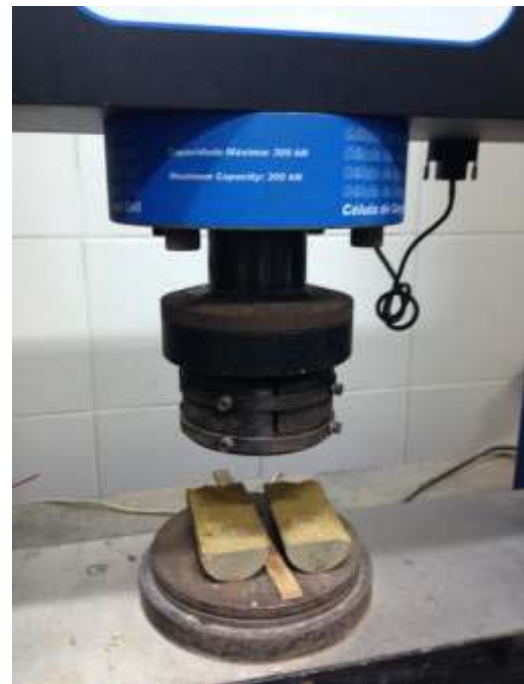
Figura 60: Ruptura do RCC94C6.
