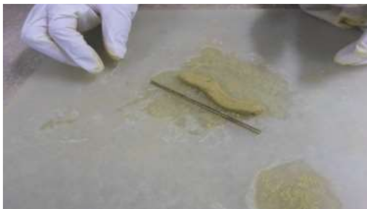
Figura 29: Execução do limite de plasticidade em uma amostra de RCC100.
